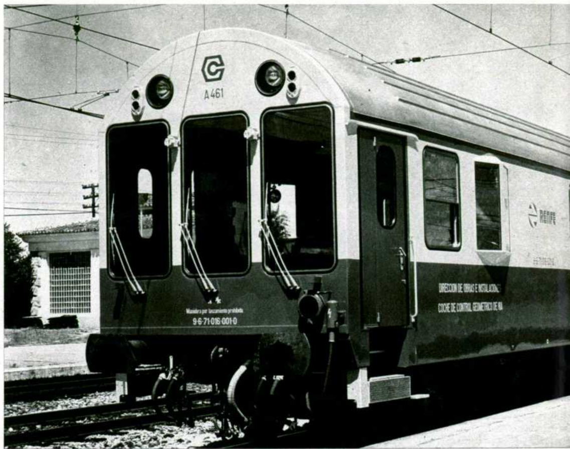
El coche de auscultación geométrica de vía servirá para mejorar el estado del tendido férreo.
