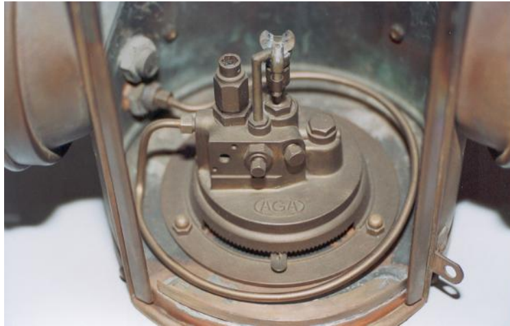
Conjunto de chiclés, principal (en "Y"), secundario, generador de destellos y solventil para auto encendido. Foto: José-María Sánchez Fernández.
