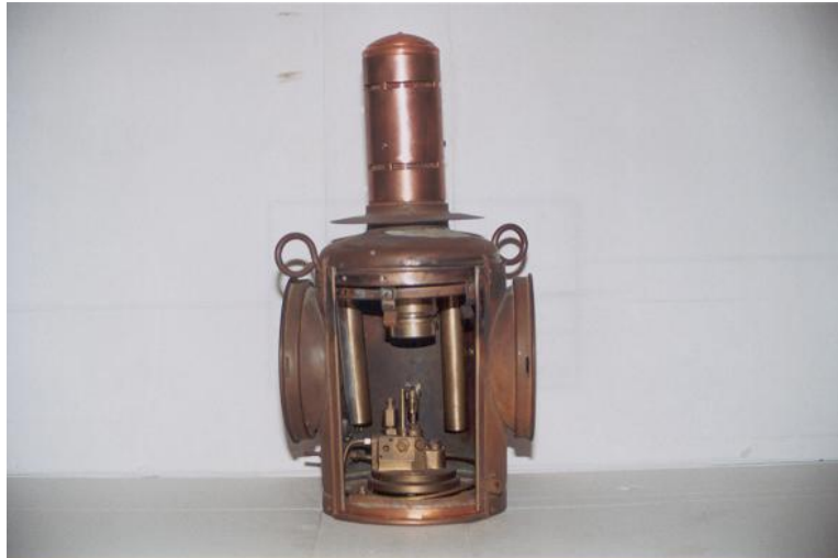
Vista del cuerpo inferior con el conjunto de chiclés en su ubicación. Tomas de admisión y portalentes. La chimenea externa está desmontada para apreciar la linterna y el derivabrisas. Foto: José-María Sánchez Fernández.
