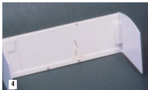
4.- Testeros unidos a un lateral. Fijarse bien en los refuerzos interiores de las esquinas.
