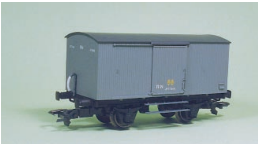
7.- Aquí vemos en el centro de la puerta las chapitas de cierre para el candado, el picaporte, el tope final de las guías y los estribos de LIMA..
