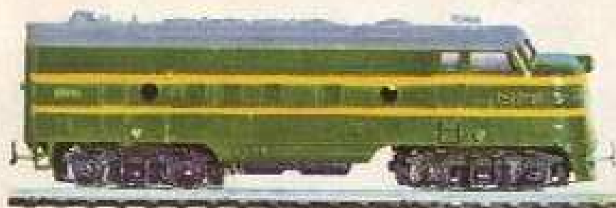
Nº 1000.-Locomotora diesel, pine frenos rápidos y mercancías de 4 ejes, construida toda ella de fundición metálica, enganche automático adelante y atrás y luz frontal. Largo entre enganches: 18 cms.
