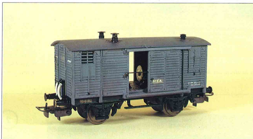
Furgón calderín ya transformado en el que podemos observar las modificaciones siguientes: mangueras de vapor en el testero, chimeneas y ventilador en techo, depósito de agua y carbón en el interior, barra de seguridad en la puerta, pintura y las inscripciones de MZA.
