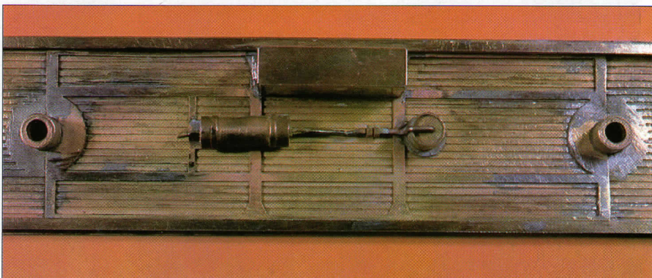
2.- En esta foto podemos observar, en el bajo del bastidor, la caja de baterías, el cilindro y la reserva de freno, así como la modificación de la pieza P7.
