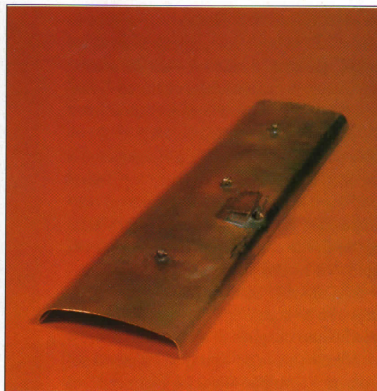
10.- Vista, previa a su colocación, del techo curvado y con los ventiladores y depósito de agua ya soldados.
