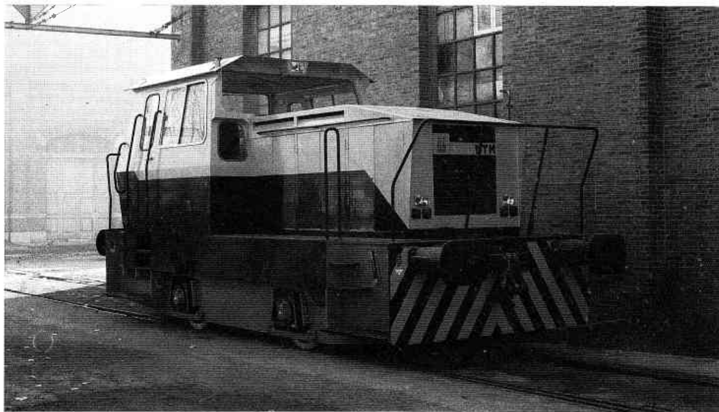
El prototipo DH-200 en su estado original, sin freno continuo, en 1978. (Foto Jordi Torres).
