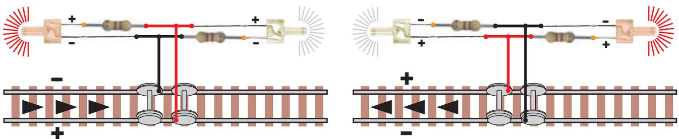
Este simple y práctico montaje solo es válido para el material rodante de las maquetas analógicas de 2 carriles. Para analógicas de 3 carriles y digitales de 2 y 3 carriles, imposible aplicarlo. En digitales, a través del decoder.
