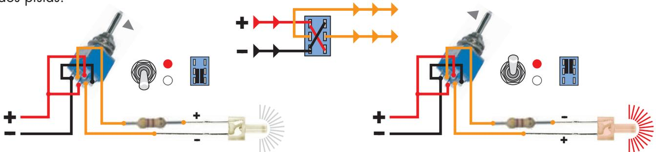
Si se utiliza un led bicolor blanco/rojo de dos patillas para incorporar luz en una locomotora o vagón piloto que circule sobre una maqueta de 2 carriles analógica, la inversión de polaridad dependerá de la polaridad de la vía y, por tanto, del sentido de la marcha. De este modo, en marcha hacia delante puede iluminarse en blanco, y en marcha hacia atrás puede iluminarse en rojo.
