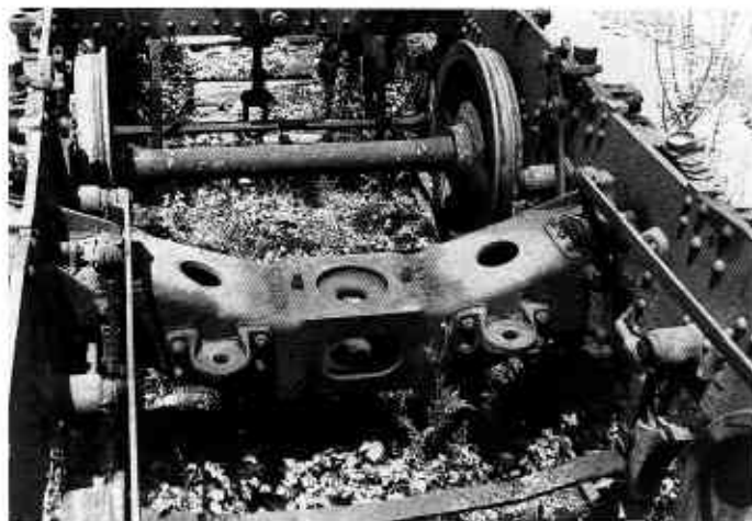
Detalle de la traviesa interior del bogie, donde se aprecia su curvatura para recibir el pivote y los dos soportes de uno de los motores de tracción (Foto E. Ramírez).
