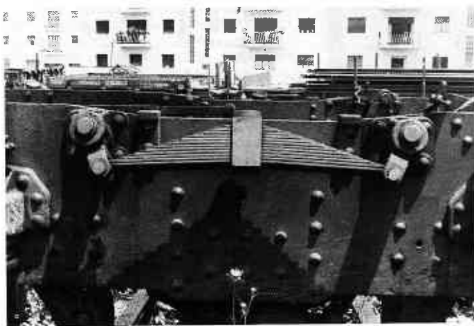
Detalle de uno de los dos equilibradores de resorte con los que va equipado cada bogie (Foto E. Ramírez).
