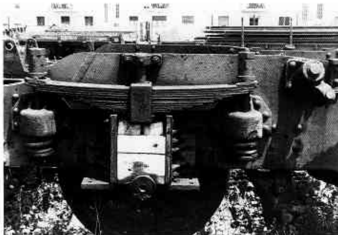
Ballesta de la suspensión. El bogie de la fotografía descansa sobre unos ejes provisionales de UT, ya que se trata de la desguazada locomotora 1007 (Foto E. Ramírez).
