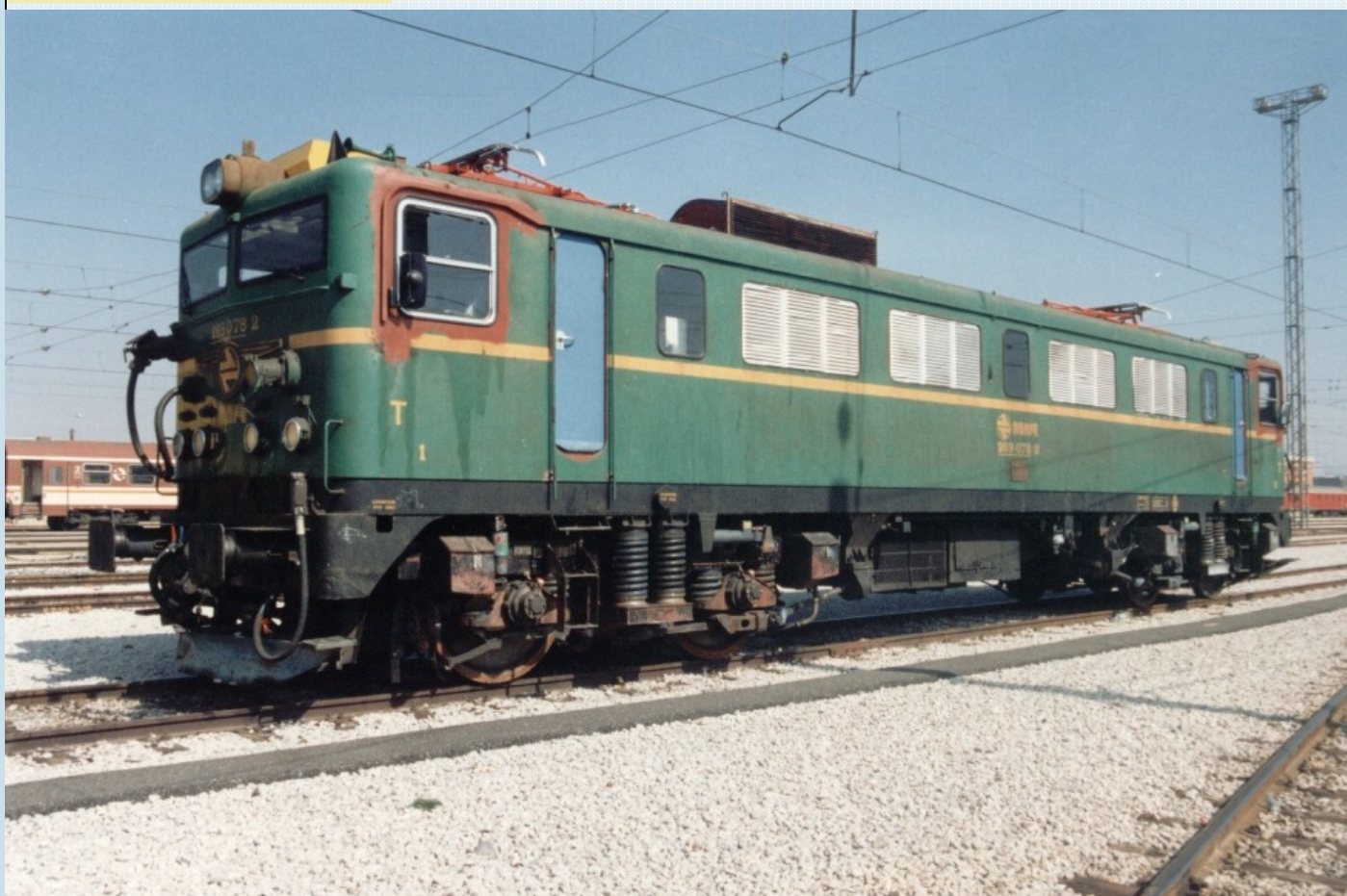
RENFE 269.078 EN OBRAS. SE APRECIA QUE YA SE LE HA INSTALADO EL FARO DOBLE, ASÍ COMO VENTANILLAS MODERNAS Y LUNAS BLINDADAS.
