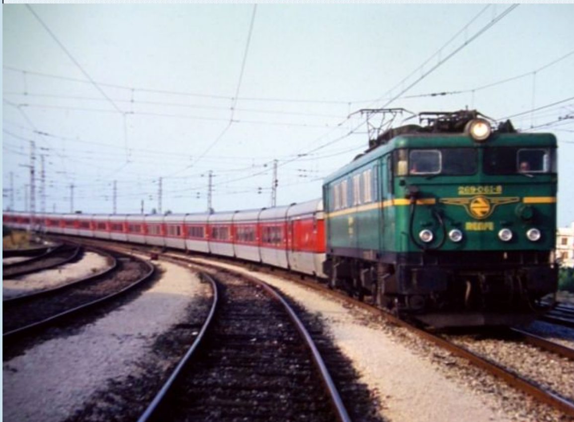
RENFE 269.031 CON EL ESCUDO NUEVO Y FARO SIMPLE REMOLCANDO UNA RAMA DE TALGO III
