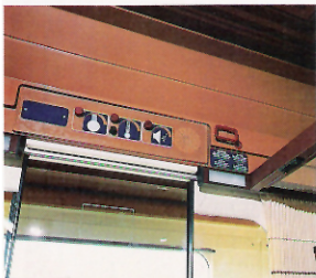
Luz de penumbra, pictogramas de alumbrado, aire acondicionado, sonorización y empuñadura de freno de alarma
