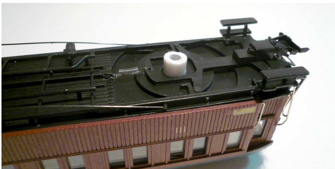
Foto nº 6-B – Tetón para anclar el nuevo bogie.
