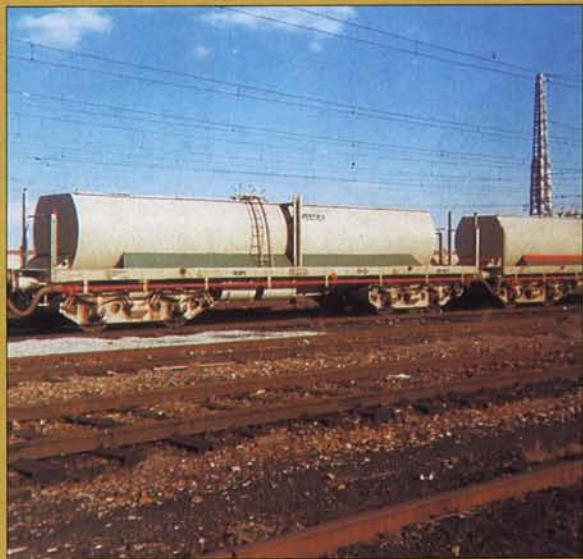
▲ La cisterna de weedex, colocada antes del coche taller, estaba rotulada con esa palabra y tenía la franja pintada de color verde. Las Matas (20/03/75). MGM
