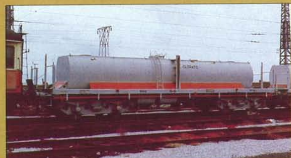
◀ Tras el furgón se enganchaban cuatro cisternas de clorato que se distinguían a simple vista por la franja roja. Todas las cisternas procedían de la transformación de los vagones plataformas Q de Andaluces. Las Matas (20/03/75 y 27/01/77). MGM
