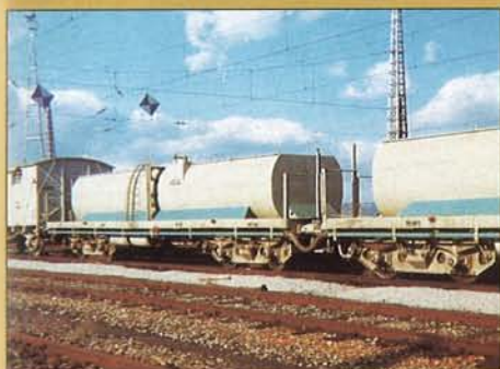
Las cisternas de agua lucían una franja ▲ azul y tenían una boca de carga lateral de especial cometido en líneas electrificadas. Las Matas (20/03/75 y 16/07/77). MGM
