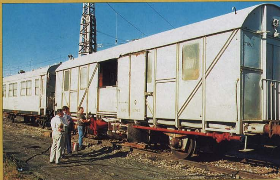
▲ Elemento clave para el riego era el coche taller donde se efectuaba la mezcla adecuada del herbicida. Las Matas (noviembre/89). Cortesía Sintra
