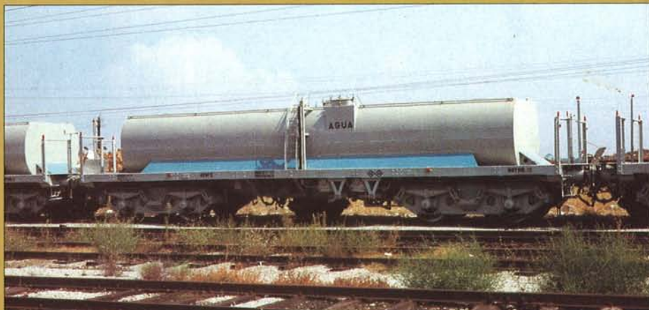
Las cisternas de agua lucían una franja ▲ azul y tenían una boca de carga lateral de especial cometido en líneas electrificadas. Las Matas (20/03/75 y 16/07/77). MGM
