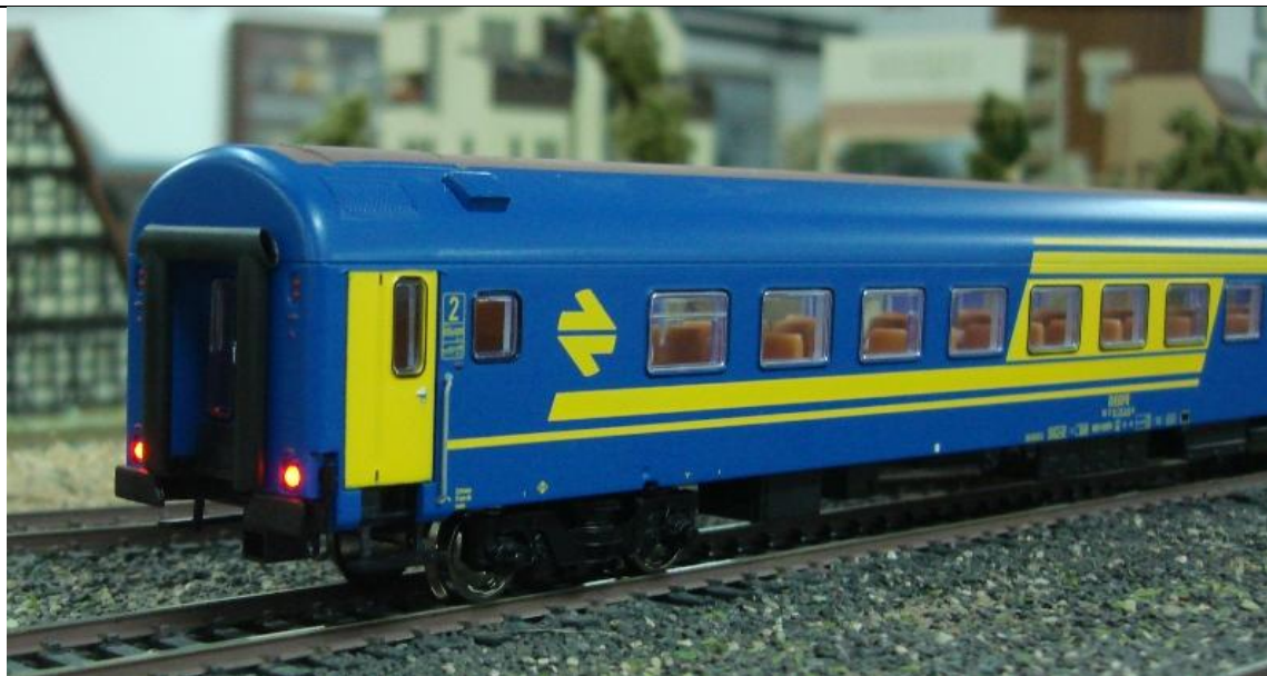
Resultado final de una tira de iluminación con luces de cola sobre un coche 9000 de Roco
