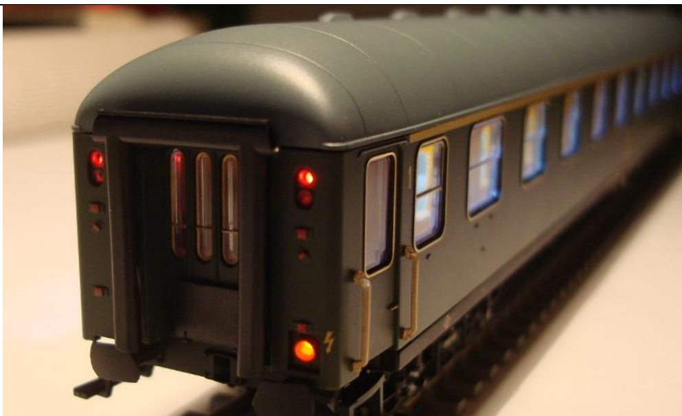
Detalle de las luces de cola instaladas en un 8000 de Electrotren
