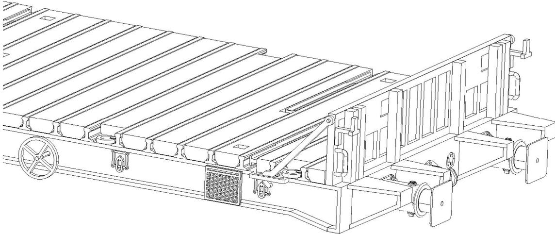
18. Colocación de los ganchos de maniobra. En esta ocasión, las piezas a colocar son distintas en función de la versión que esté construyendo. En caso de construir la versión de origen en época IIIb (versión A) deberá colocar las piezas nº 20 tal como se muestra en la figura de la izquierda. Para el resto de versiones, deberá utilizar las piezas nº 21 y colocarlas según la imagen de la derecha.
