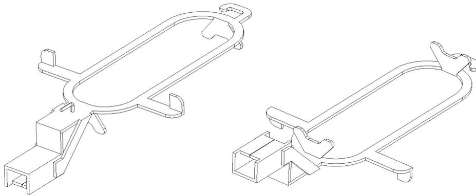
22. Monte los mecanismos en la tolva como se muestra en la figura, con la ayuda de los muelles suministrados. Para montar el muelle, construya un pequeño gancho con varilla y suéldelo en el orificio existente en el falso bastidor. Ajuste la tensión de los muelles de forma que el giro del mecanismo no ofrezca excesiva resistencia. Asegúrese además que esta pieza gira suavemente, sin bloquearse.
