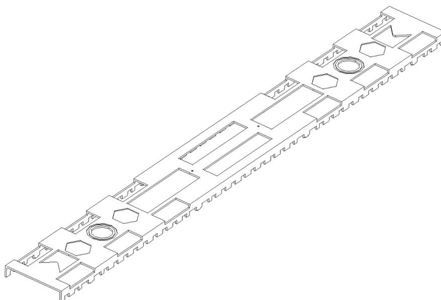
2. La pieza nº 2 contiene todas las tablas que configuran el entablillado del piso del vagón. En el blister vienen ordenadas convenientemente y espaciadas a la distancia necesaria para insertar entre ellas los carriles que conforman el piso de la plataforma. Para evitar tener que posicionarlas una a una, lo que vamos a hacer ahora es soldar todas las tablas al falso bastidor **ANTES DE SEPARARLAS** del blister. De esta forma se simplifica notablemente esta operación.
