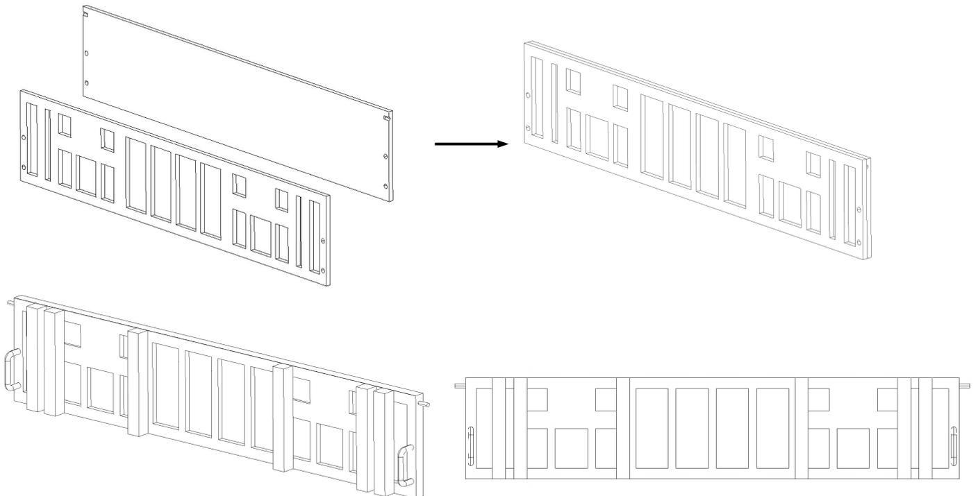
14. Monte ambos testeros en el bastidor, cuidando que queden perpendiculares, y suéldelos por la parte interior.
