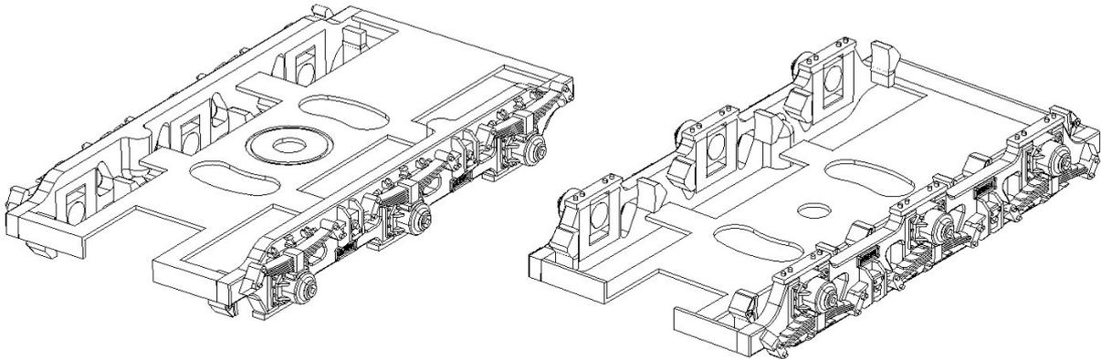
24. Monte los ejes y compruebe que éstos giran libremente, sin rozar. Si rozan, haga un poco más profundos los alojamientos cónicos de los ejes con ayuda de una broca. Tome el trozo de tubo de diámetro 8 mm y suéldelo al travesaño, encajándolo en la ranura circular.
