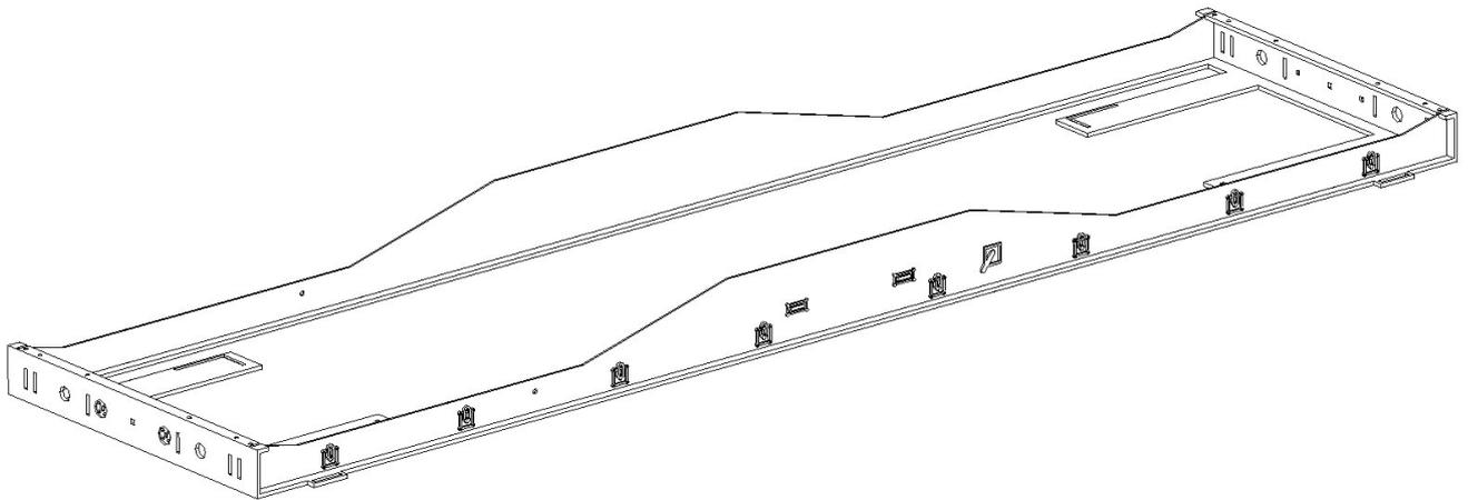
10. Tome las tiras nº 7 y doble por los pliegues grabados, siguiendo el perfil de la pieza nº 6. Colóquelas y suéldelas en toda su longitud por la parte interior. La ranura que llevan grabada en toda su longitud encaja en la pieza nº 6. Las dos entallas van montadas hacia la parte interior del bastidor y sirven para permitir el giro de los bogies en radios reducidos.
