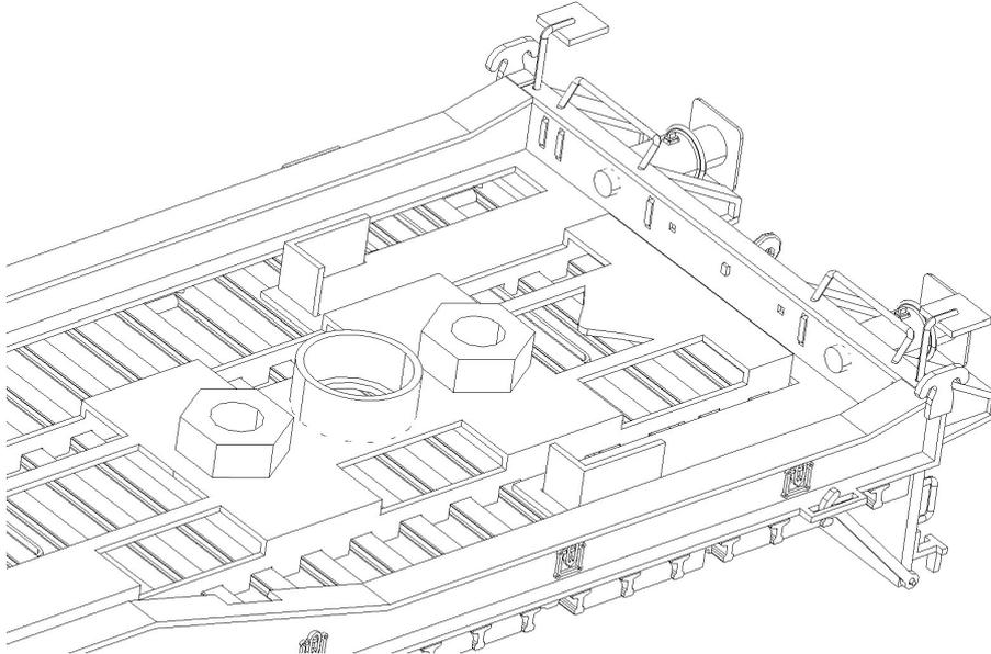
21. Montaje de los mecanismos de elongación. Corte las piezas 24 y dóblelas a 90° por los pliegues grabados. Suelde los extremos de tal manera que se forme un cajetín NEM y refuerce el resto de pliegues con soldadura. Taladre el agujero marcado con una broca de 0.5mm. Suelde una varilla doblada a 90° como se muestra en la figura.
