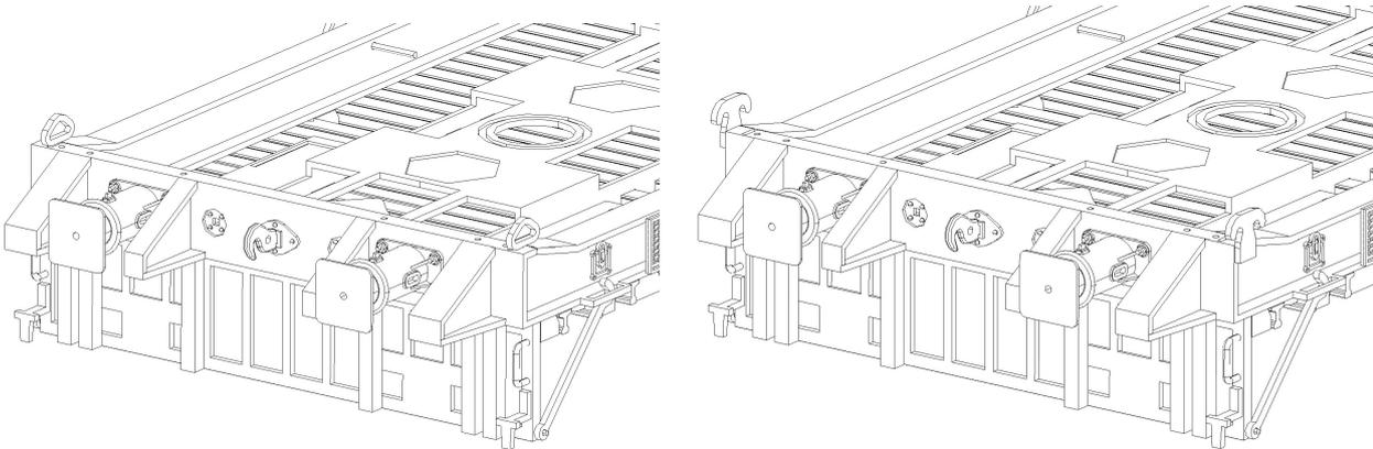
19. Con varilla de 0.4 mm construya los pasamanos de debajo de los topes tal como se muestra en la figura. Con las piezas nº 22 y trozos de varilla de 0.6 mm, construya los estribos de maniobra.
