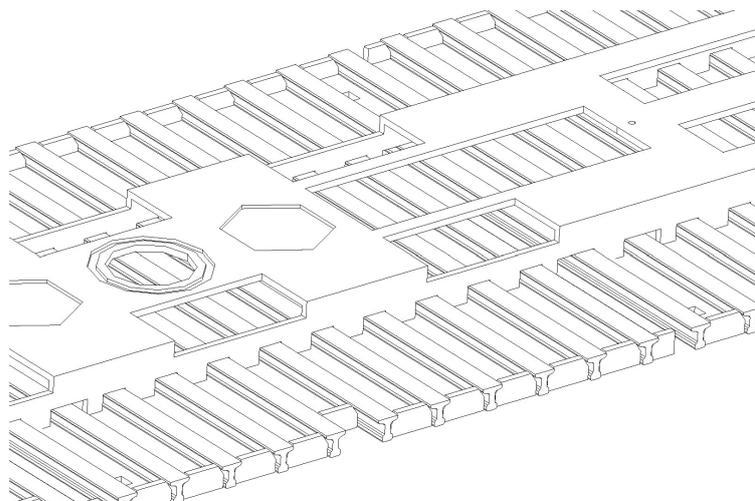
6. Procedemos a construir los teleros. Tome las piezas número 3 y 4, y con ellas construya ocho teleros de la siguiente forma: Doble una pieza núm 3 por la mitad a 180°, de manera que forme una "U" muy alta, e inserte en su interior una pieza núm 4. Una ambas piezas con una pequeña cantidad de soldadura.
