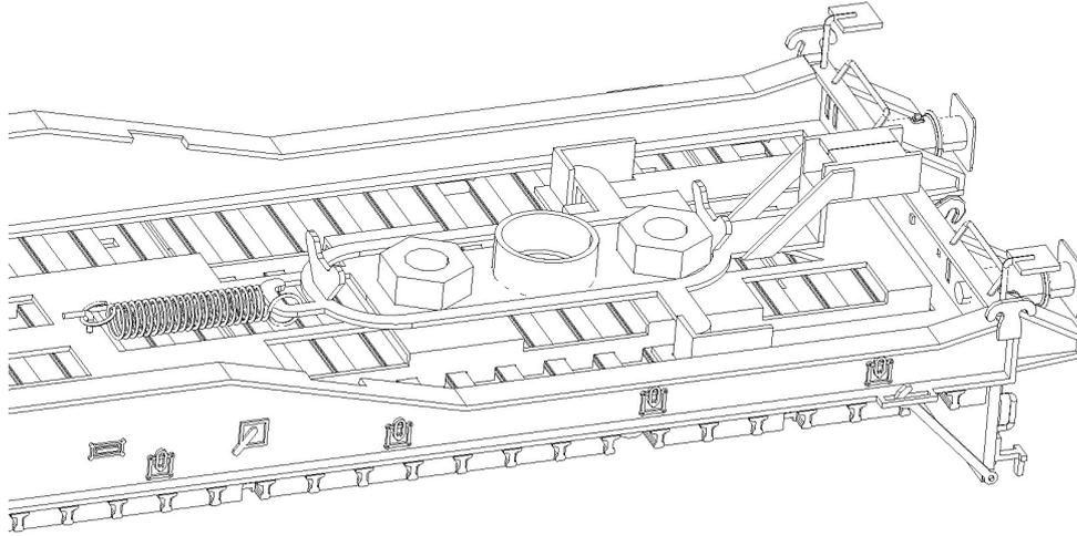
23. Montaje de los bogies. Doble a 90° los extremos de la pieza 25, con la que se forma la estructura del bogie. Tome los laterales de latón fundido y recorte la colada enrasándola con la cara superior del bogie. Suelde los laterales al travesaño tal como se muestra en la figura, asegurándose de su correcto paralelismo.
