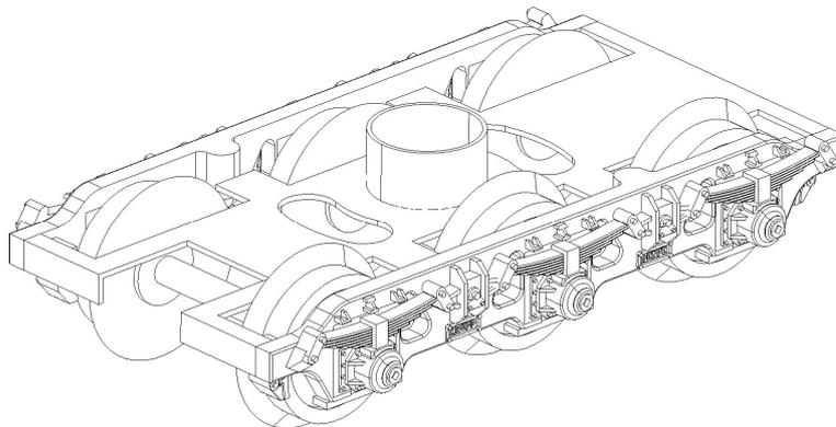
25. Para finalizar, monte los bogies mediante los 4 tornillos M3. Para evitar que los ejes se salgan de su posición, tome la pieza nº 26, haga los pliegues a 90°, refuércelos con una pequeña gota de soldadura y móntela entre el bastidor del bogie y los tornillos, tal como se muestra en la figura. Los tornillos, una vez apretados, deben permitir el giro libre del bogie. Si no fuera así, rebaje ligeramente la altura del tubo de diámetro 8 mm.
