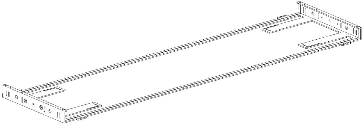
9. Recorte las piezas nº 6 y colóquelas tal como se muestra en la figura, encajándolas en las ranuras del larguero y con los detalles grabados hacia la parte exterior del vagón. Suéldelas en toda su longitud y a los extremos por la parte interior.
