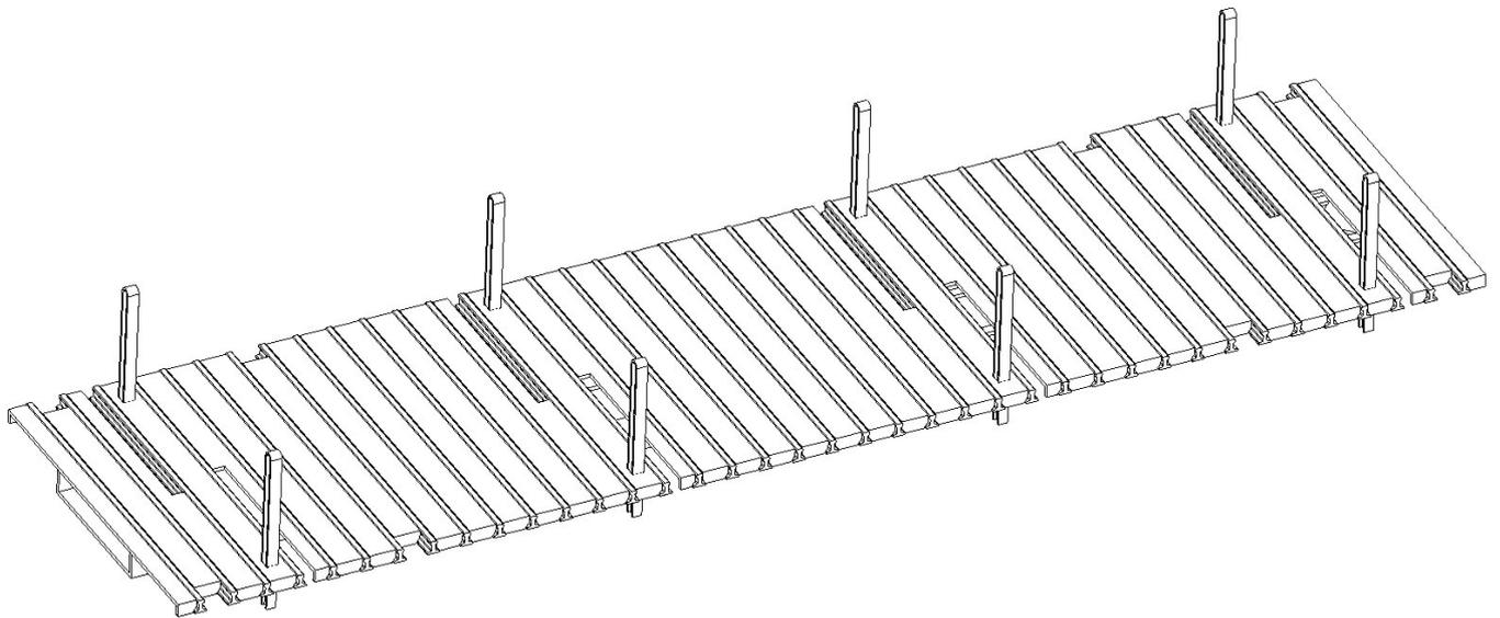
Con esto finaliza la construcción del piso de la plataforma.
