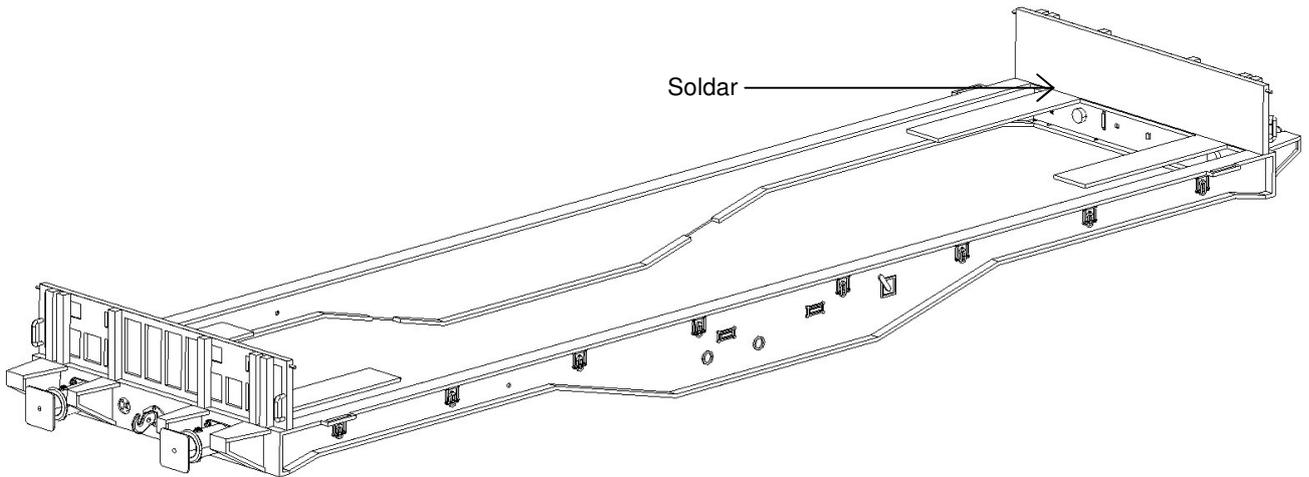
15. Pasamos ahora a montar el piso en el bastidor. Para unirlos, suelde por la parte interior los carriles a la viga exterior.
