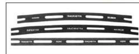
Gleisbauschablonen aus Aluminium Sie sind so konstruiert, dass sie zwischen die Gleisprofile geklemmt werden kön- nen, um das Gleis in den gewünschten Radius zu biegen. Eine ausführliche An- leitung liegt jeder Schablone bei.
