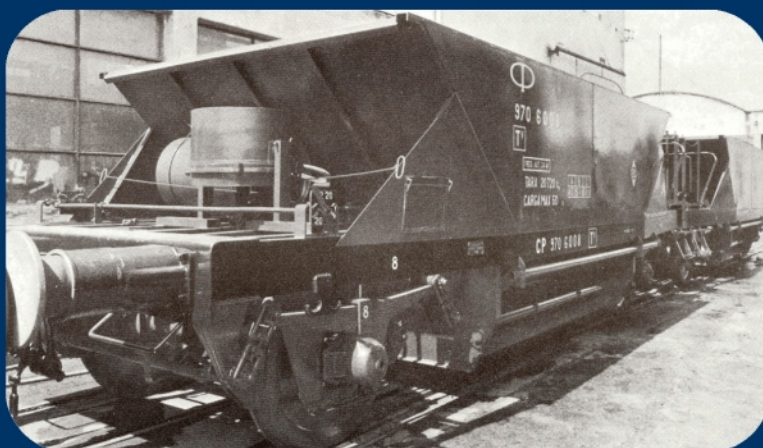
Vagão Tv da série 6 001 a 6 110 com leito pintado de preto e símbolo CP antigo construído pela ARBEL - França
