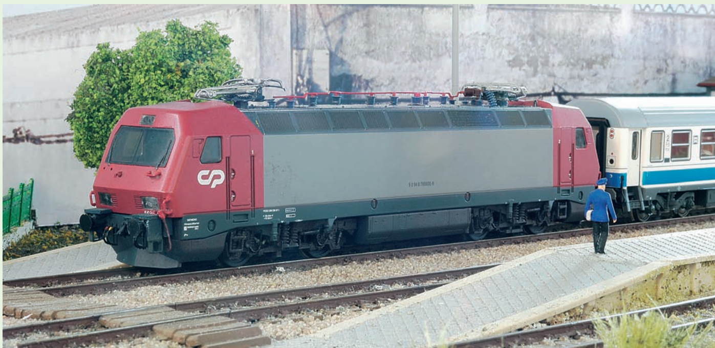
El maquinista baja el pantógrafo para que se puedan enchufar las mangueras eléctricas que conectan la locomotora con los coches.
