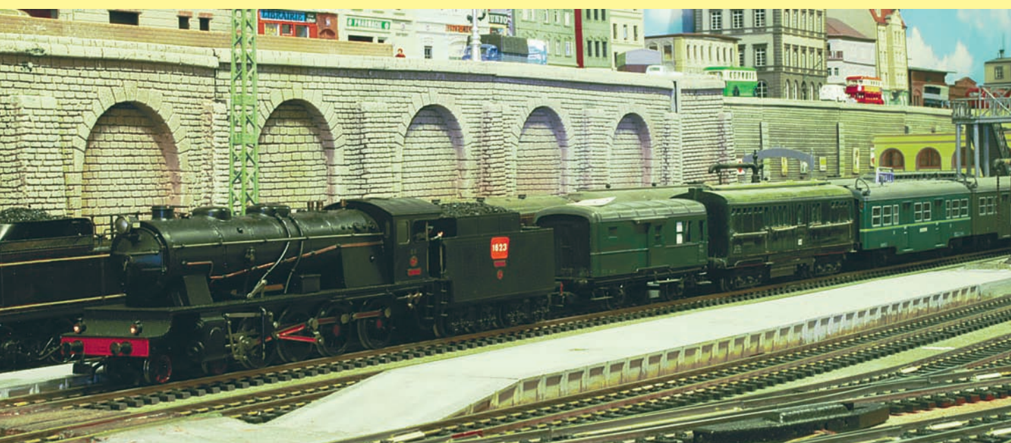
Una máquina "1600", procedente del depósito, toma el relevo. Las ruedas de menor diámetro son adecuadas para el perfil más accidentado de esta parte del trayecto del tren.
