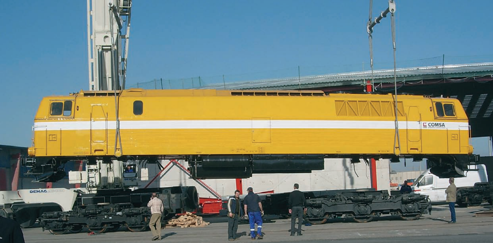
Momento de la colocación de los bojes ibéricos en la 1442. (Puerto de Tarragona, 18/03/2005)
