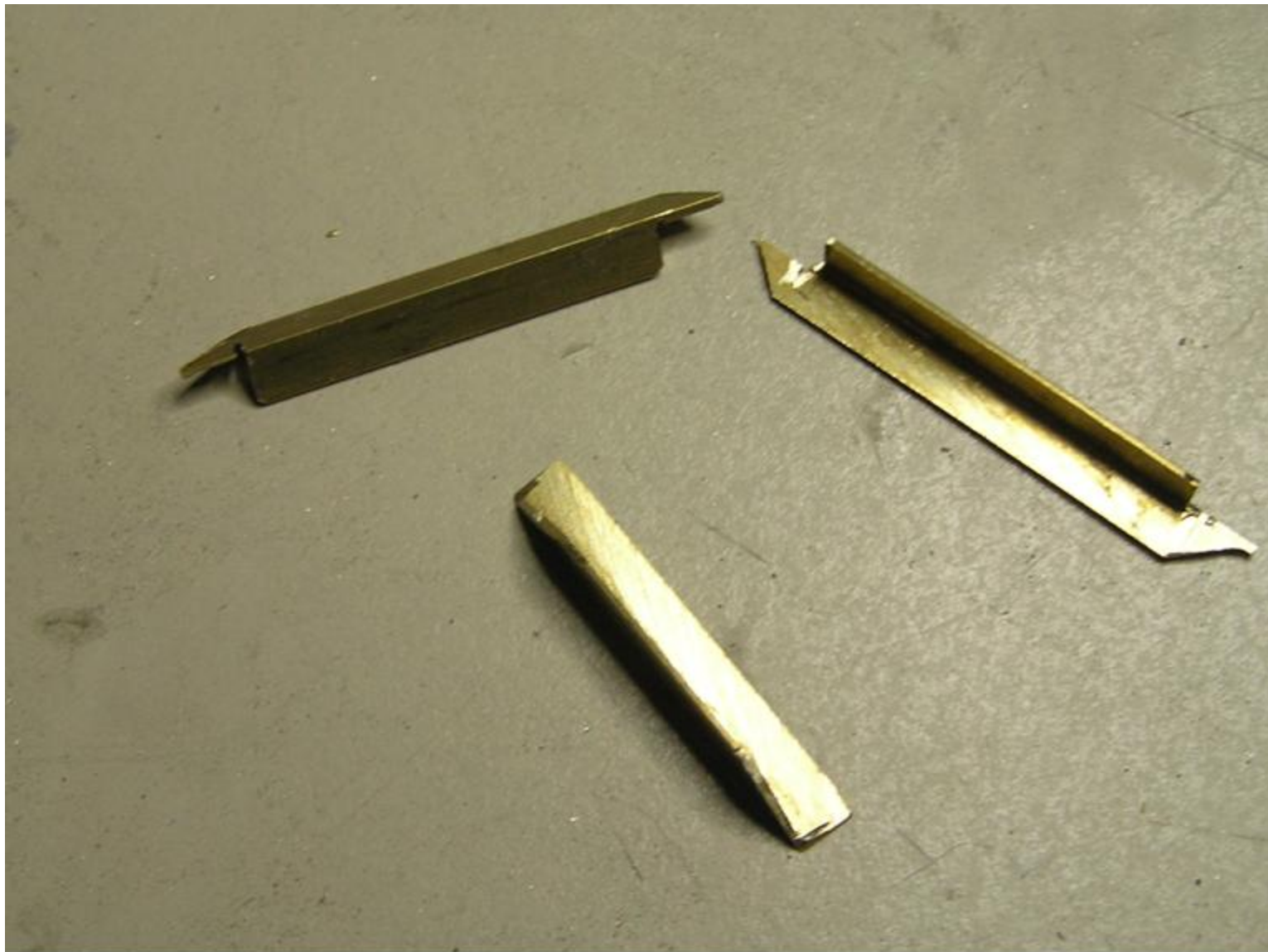
Preparé unos ángulos de latón a modo de refuerzos
