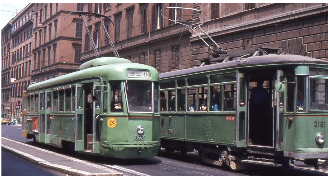
PCC-8021 y MRS-2161; observar el curioso sistema de liras de captación de corriente
