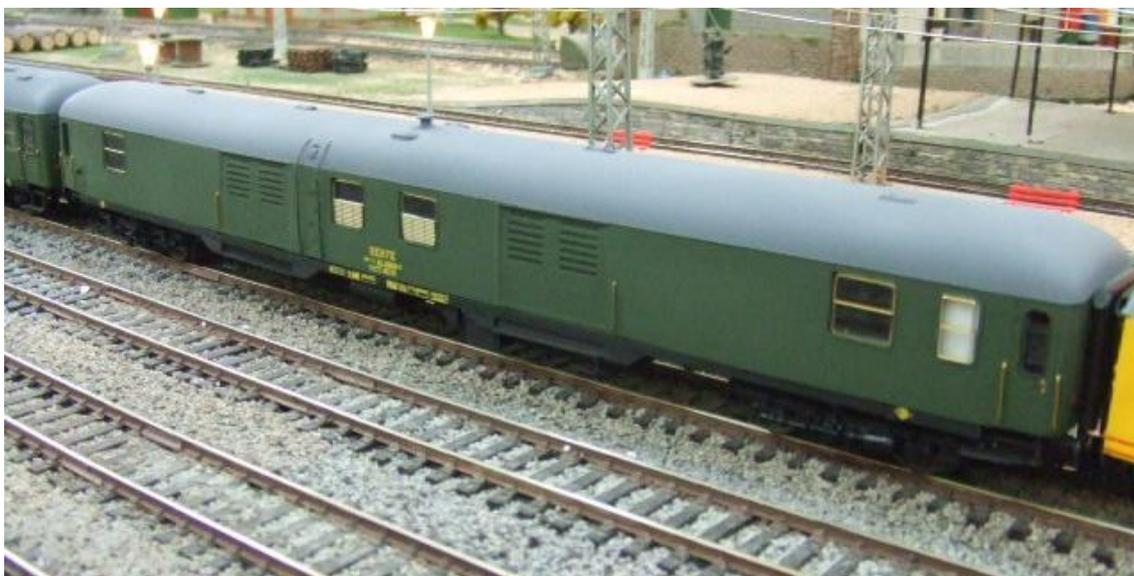
Se trata de un DDT con calderín de serie baja, puertas de persiana grandes; se basa en la carcasa de resina de Microtren, con un chasis procedente de un coche DB de Jouef, a escala exacta y con bogies MD del modelo que utilizó Renfe. Esta asignación es circunstancial, ya que el anotado y fotografiado es de serie alta, con puertas de persiana pequeñas y además con el pantógrafo experimental. Como comenté antes, también existe la posibilidad de acceder al modelo en kit de
