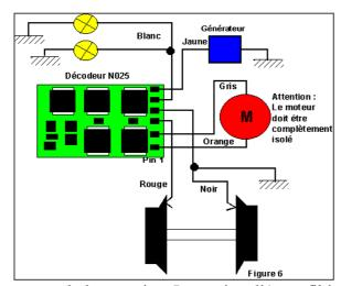
Pour brancher une fonction complémentaire sur le N025 (générateur de fumée, par exemple), il faut programmer les sorties de fonctions pour qu'elles soient indépendantes de l'exploitation. Le réglage doit être effectué dans le registre 1 de l'utilisateur (CV#56). Il faut y inscrire le Bit 0.
