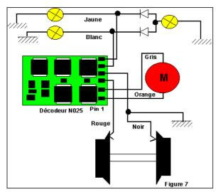
Les sorties de fonction sont programmées dépendantes du sens de marche. Le décodeur est réglé tel que, en sortie d'usine. Le réglage doit être effectué dans le registre de configuration 1 de l'utilisateur (CV#56). Pour cela, il faut effacer le Bit 0 dans ce registre.
