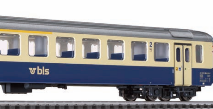
AB 50 63 30-33 816-7, mit Gummiwulst, Außenschwing- türen, Federpuffer, LüP 272 mm.
