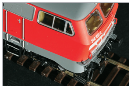
Durchbrochene Trittstufen aus Ätzteilen
