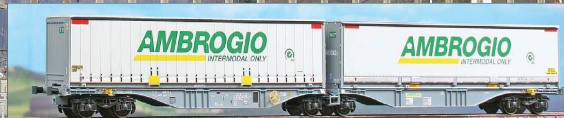
Carro intermodale Tipo Sggrss '90 bimodulo di proprietà Ambrogio caricato con due casse mobili "Ambrogio" Container wagon Type Sggrss '90 Ambrogio with two "Ambrogio" swap bodies Containerwagen Typ Sggrss '90 Doppelmodul der Ambrogio mit zwei "Ambrogio" Wechselpritschen
