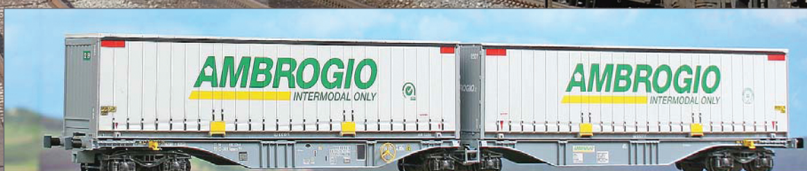
Carro intermodale Tipo Sggrss '90 bimodulo di proprietà Ambrogio caricato con due casse mobili "Ambrogio" Container wagon Type Sggrss '90 Ambrogio with two "Ambrogio" swap bodies Containerwagen Typ Sggrss '90 Doppelmodul der Ambrogio mit zwei "Ambrogio" Wechselpritschen
