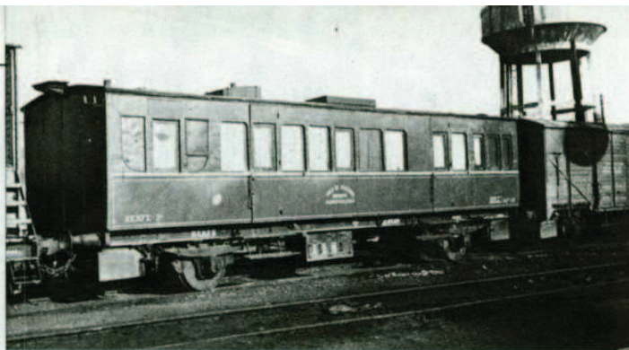
El coche de socorro de Delicias (SA FHV 101), transformado de un coche de primera clase de pasillo parcial de Andaluces. Fue una lástima que no se pudiera conservar para el Museo Ferroviario.
