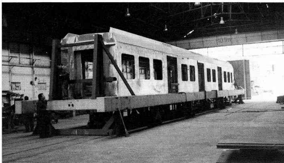
Remolque intermedio de la UT 445 en construcción en la factoría de MACOSA. (Foto: Luís Rentero Corral, 27.06.85).
