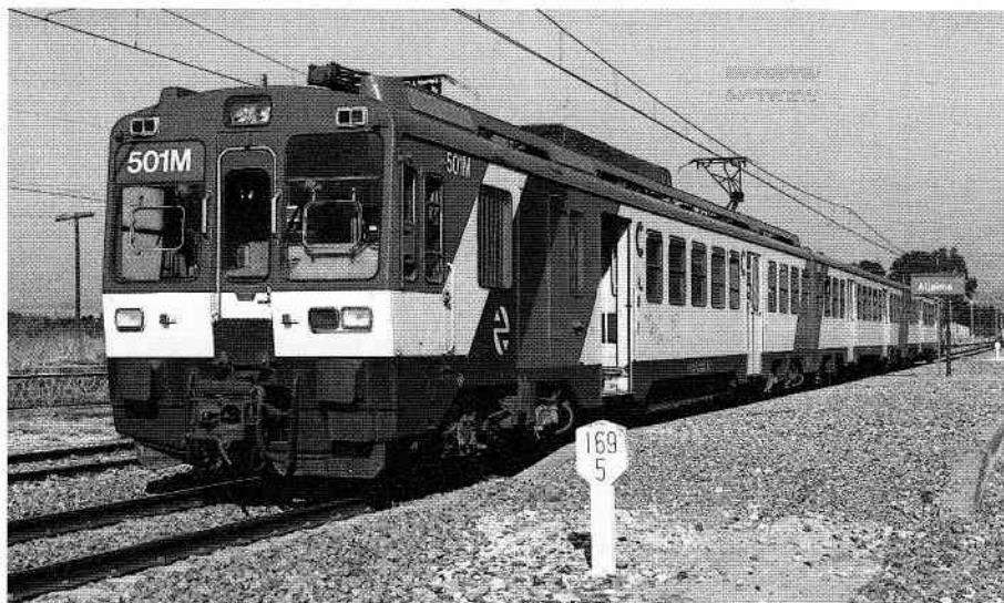
La 440.501, con equipos de potencia basados en el uso del troceador, captada en la estación de Aljaima el 30 de junio de 1993 realizando el tren de cercanías 23613 Alora-Málaga. (Foto: Juan Martín Padilla ).
