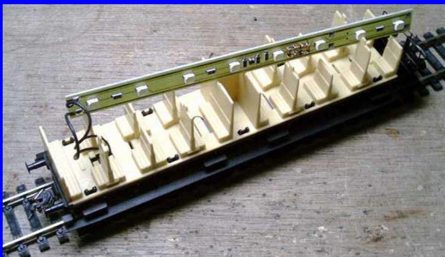
La tira con LED´s se puede pegar al techo con un poco de cinta adhesiva de doble cara o simplemente apoyarla o fijarla sobre los compartimentos interiores procedemos a cerrar el vagón de nuevo. Como la luz de los LED s es fría, no tendremos problemas de deformaciones del techo por temperatura.
