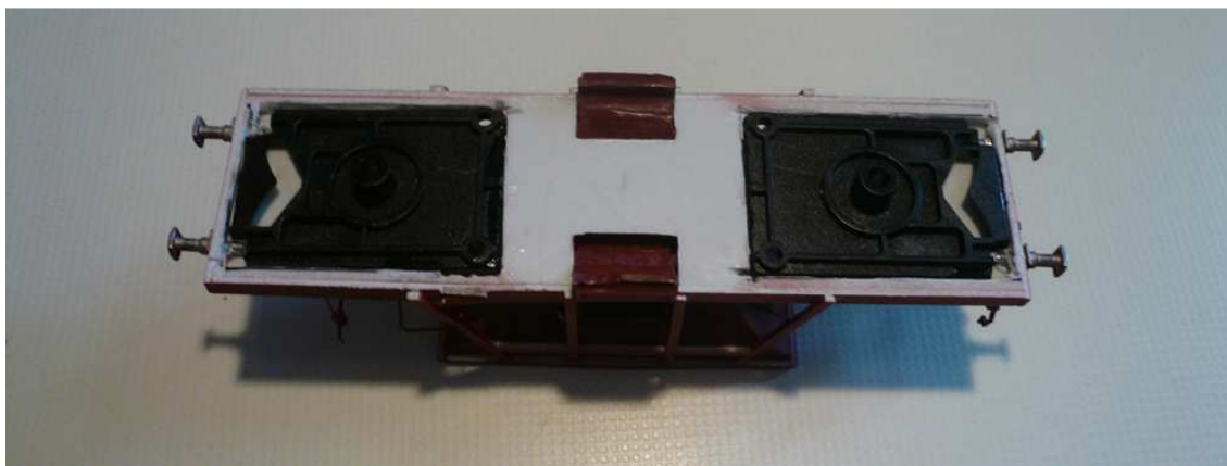
Foto nº 8 - Soportes para fijar los bogies y las cinemáticas.
