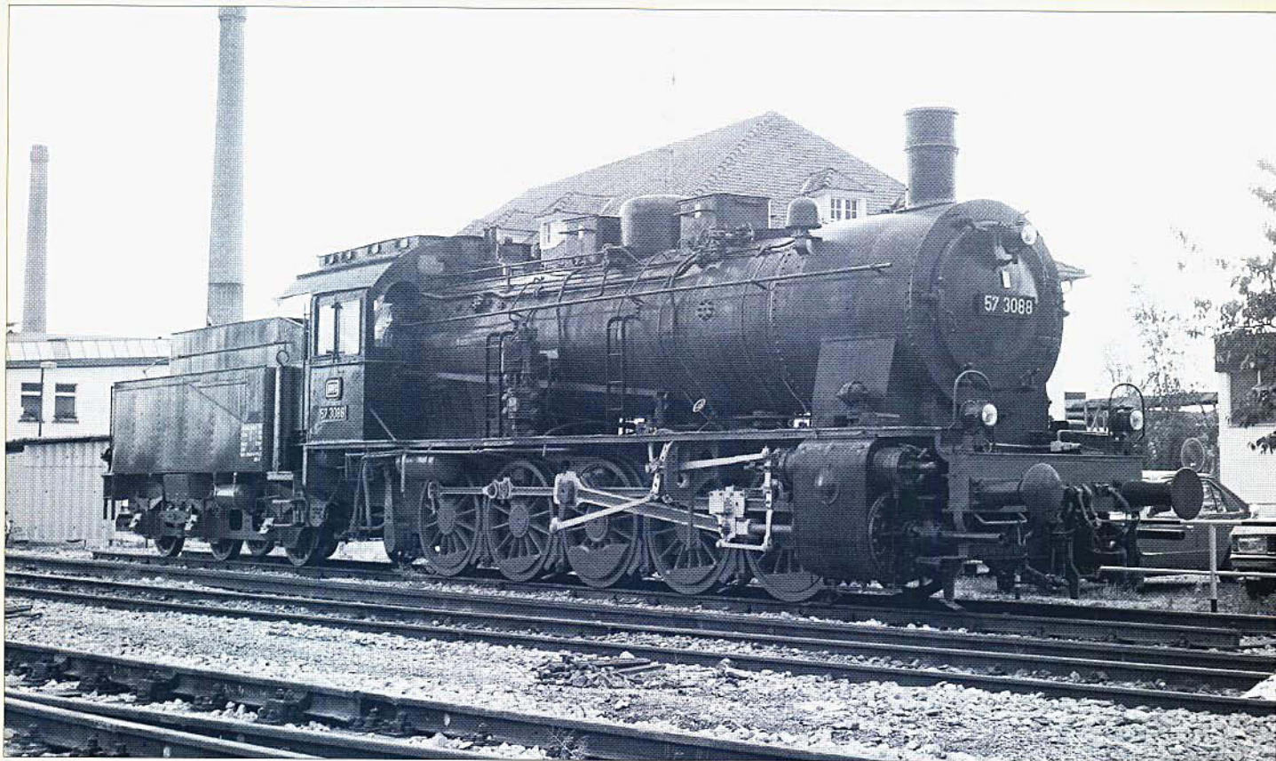
Bild 127: Insgesamt ungefähr 3000 Lokomotiven wurden von der fünffach gekuppelten preußischen G 10, der späteren 57 10-35 , in Dienst gestellt. In den Bestand der Deutschen Reichsbahn kamen noch 2385 Stück, wovon die abgebildete dreidomige 57 3088 ein Beispiel sein soll.
