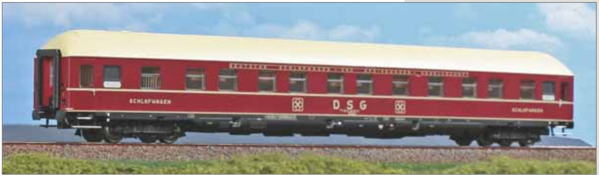
Carrozza letti WLABmh 174 con carrelli München-Kassel della DSG, in livrea rossa con carenature nere. WLABmh 174 sleeping car of DSG with München-Kassel bogies, red livery with black skirts. WLABmh 174 Schlafwagen der DSG mit München-Kassel Drehgestellen, rote Lackierung mit schwarzen Schürzen.
