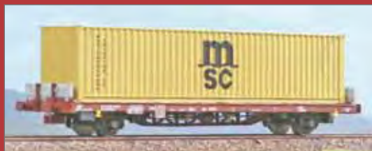
Carro pianale FS Tipo Kgps con carico di container. Type Kgps wagon of FS with container. Typ Kgps FS Güterwagen mit Container.
