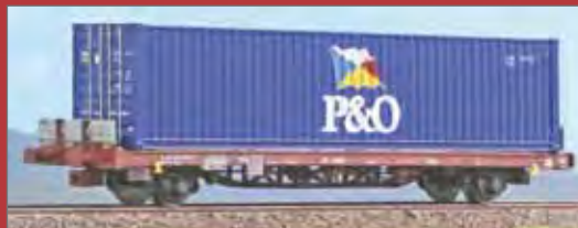
Carro pianale FS Tipo Kgps con carico di container. Type Kgps wagon of FS with container. Typ Kgps FS Güterwagen mit Container.
