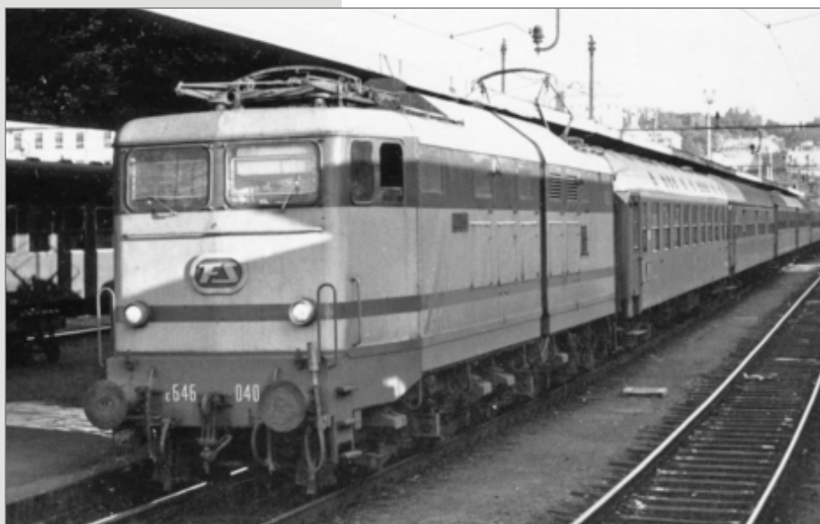
Locomotiva elettrica E.646.040, epoca IVa, senza modanature, scalette larghe, livrea con banda verde uniforme stretta. Electric locomotive E.646.040 in ep. IV status with wide ladder, smooth sides and narrow green ribbon. E-Lok E.646.040, Epoche IVa, ohne Zierleisten, breite Aufstiegsleitern, Farbgebung mit schmalen gleichmäßigen grünen Streifen.
