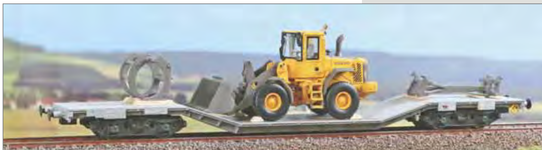
Carro ribassato FS Tipo Uai per trasporti eccezionali, con carico di escavatore ed accessori. Type Uai wagon by FS for exceptional transport, loaded with earthmover and accessories. Niederflurgüterwagen Typ Uai für Sondertransporte, mit Bagger und Zubehör beladen
