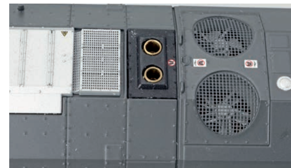
Detailgetreues Dach mit drehbaren Dachlüftern
