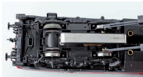
BR 215 mit aufgesetztem Schleifer
