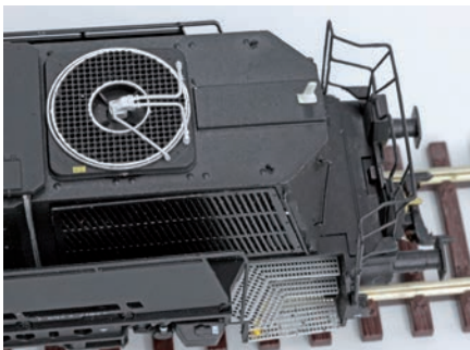
Durchbrochene Lüftergitter und Trittstufe
