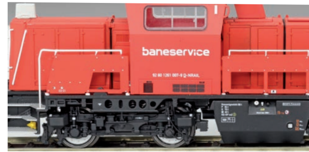
Gehäuse und Chassis aus Metall
