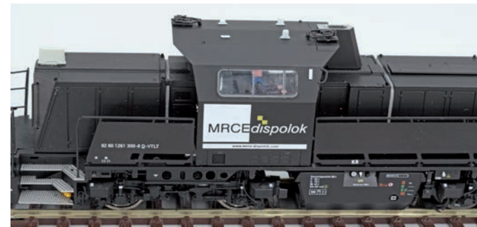
Kleinteile aus Messing und Kunststoff separat angesetzt
