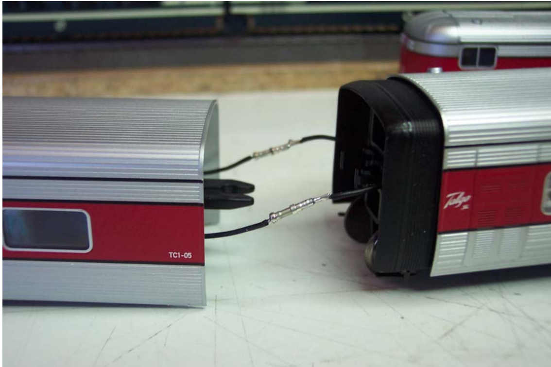
Foto 7: Coches conectados con pines.
