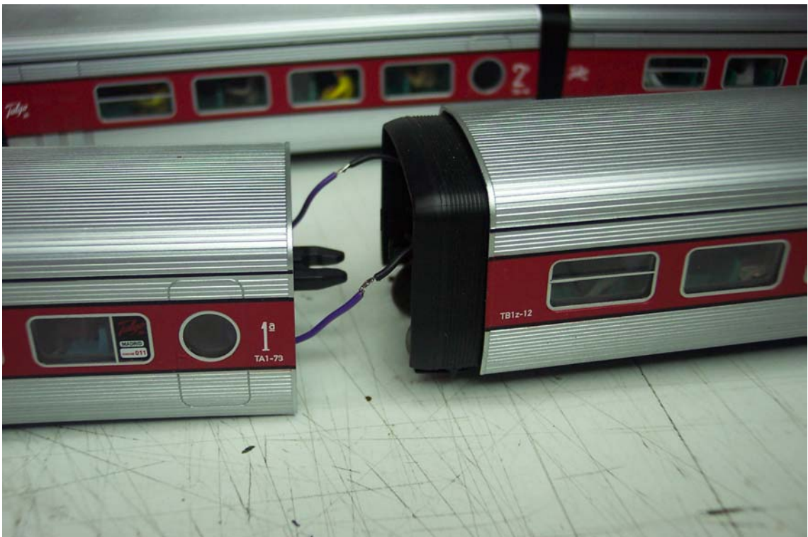
Foto 3: Cables unidos por soldadura.
