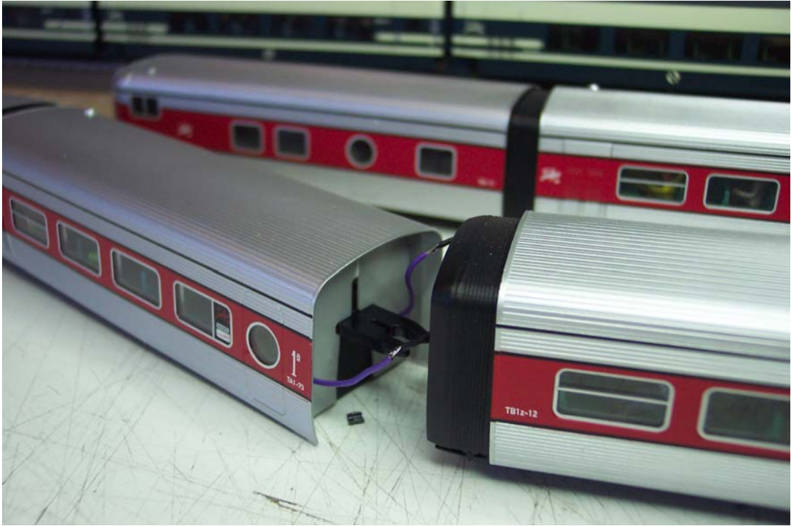
Foto 2: salida de cables lado enganche simple.
