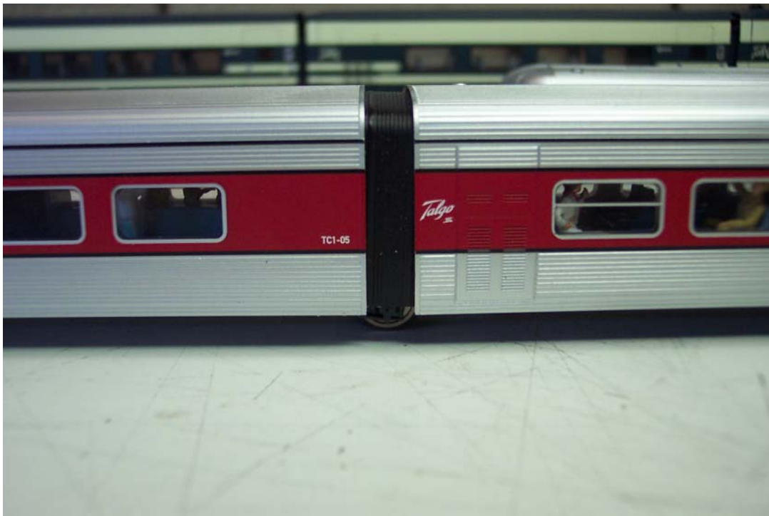
Foto 8: Coches enganchados con el cable oculto.
