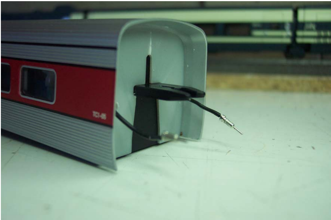
Foto 5: Conectando un lado con pines.
