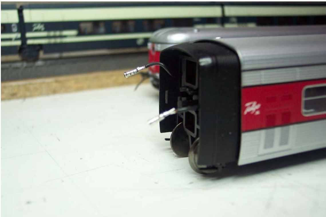
Foto 6: Conectando el otro lado con pines.
