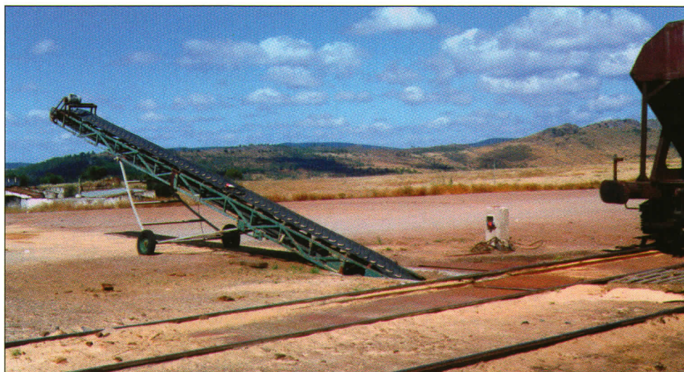
▲ Cinta transportadora portátil para carga de camiones. Entre los raíles se encuentra la trampilla de la piqueta de descarga del cereal. Zafra. 15/6/01.
