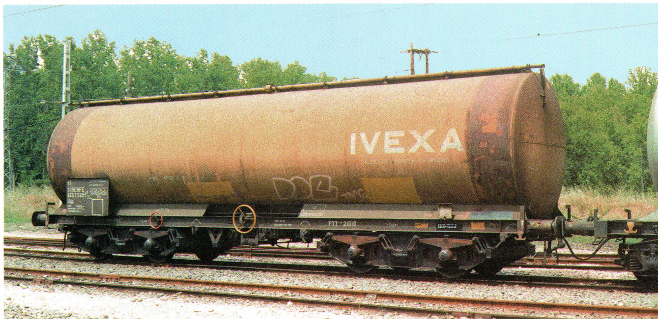
▲ Tolva PTT 21.000 (Uagps 933) de Ivexa de 80 metros cúbicos y de aspecto inusual ya que procede de la transformación de cisternas para transporte de gasolina. Aranjuez. 7/9/02.
