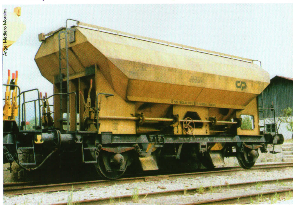
▼ Tolva Tdgs 074 de CP estacionada en la estación lusa de Elvás, próxima a Badajoz. Las firmas Roco y Lima tienen referencias del modelo de este vagón en escala H0. 20/04/03.
