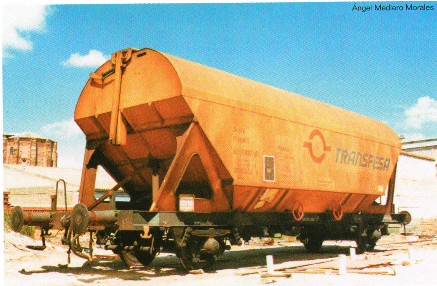
▲ Tolva de ejes de Transfesa de la serie Tps 576 apta para tráfico internacional y 56 metros cúbicos. Medina del Campo. 1/5/02.
