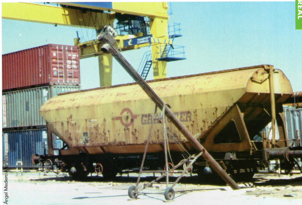
▲ Tolva Tgps 578 estacionada sobre una piqueta de descarga. El tornillo sinfín portátil servirá para trasvasar su carga a un camión. Mérida. 12/08/99.
