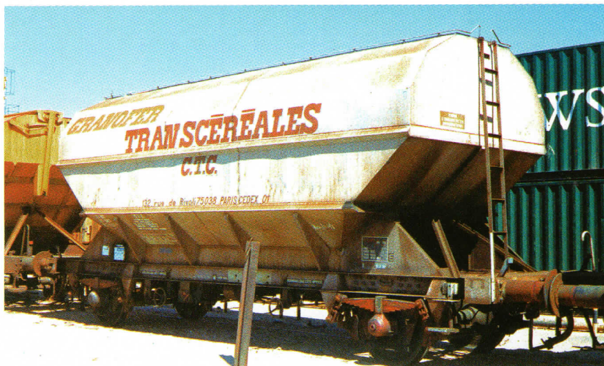
▲ Tolva de ejes francesa de CTC. Posee 2 bocas de descarga y es similar a las T1 de Renfe. Mérida. 12/8/99.
