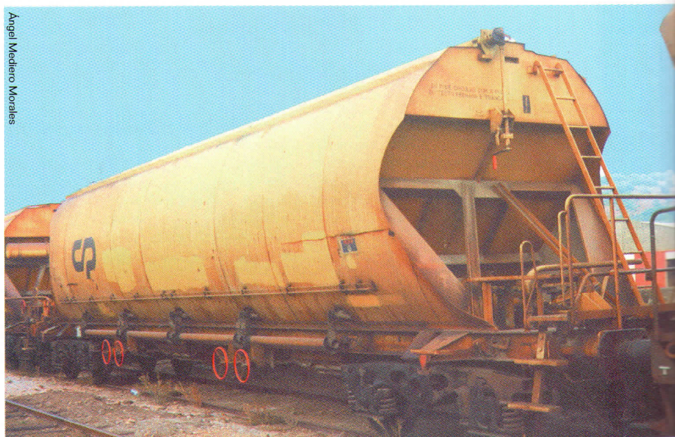
▲ Tolva de bogies Tadgs 082 de CP de circulación frecuente por España. A destacar los dispositivos presentes en la plataforma comunes a todo tipo de tolva para cereal. Elvas. 27/12/98.
