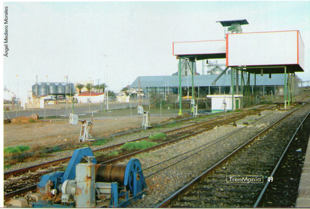
▼ El cabrestante del primer plano sirve para mover las tolvas y situarlas bajo el cargadero posterior de la empresa Merco. Don Benito. 04/01/01.
