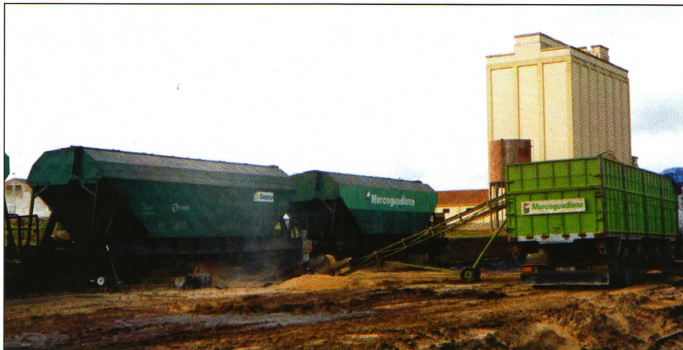
Trasvase de cereal ▲ de vagón a camión mediante cinta transportadora portátil. Castuera. 4/1/01.
