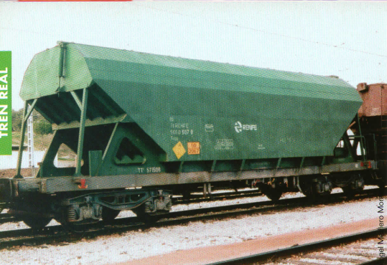
▲ Tolva TT 571.508 (TT5 segunda subserie) cargada con abonos elaborados a partir de nitrato amónico, como así lo indica el panel naranja. Linares-Baeza. 09/01/00.
