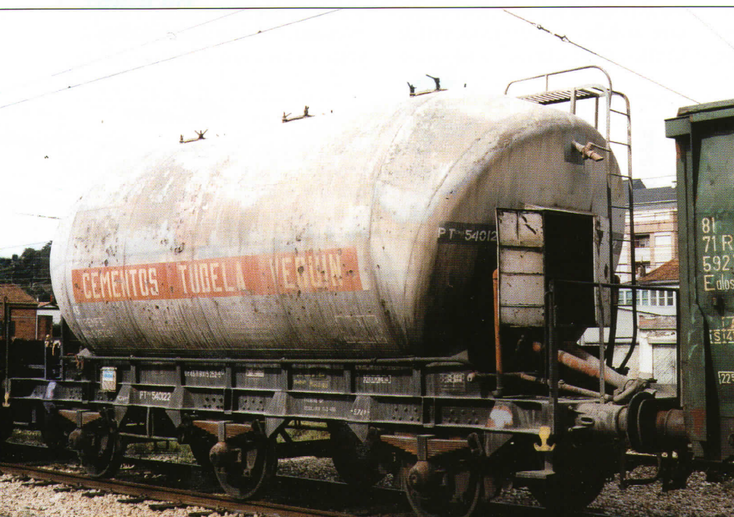
▼ Tolva PT 540.122 de descarga frontal de Tudela Veguín en Monforte de Lemos. Observad el eje central sin zapatas de freno. 20/8/01.
