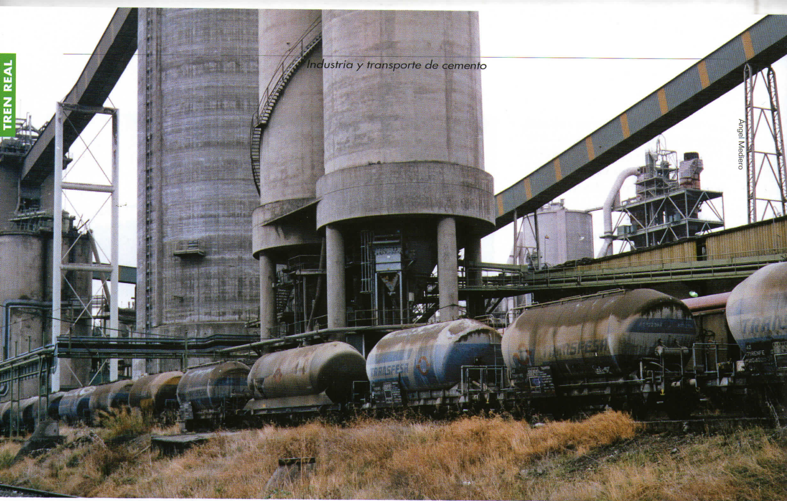
▲ Instalaciones para la carga de cemento a granel. Las tolvas de ejes PT 22.000 proceden de la transformación de las antiguas tolvas PT 540.000. Villaluenga-Asland. 5/12/00.
