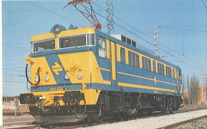
Pantógrafo semiorboidal en las locomotoras eléctricas de la serie 269.
