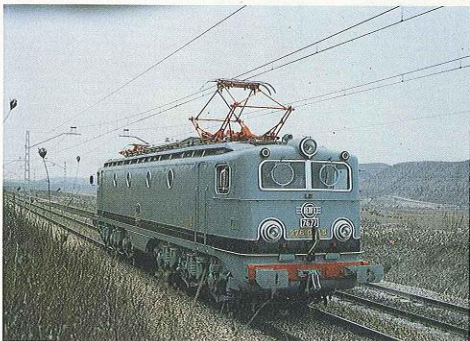
En las locomotoras de la serie 276 se empleaba inicialmente el pantógrafo del tipo romboidal que ha sido abandonado en casi todas ellas en beneficio del semirromboidal.
