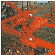
Detalle del mecanismo de elevación.
