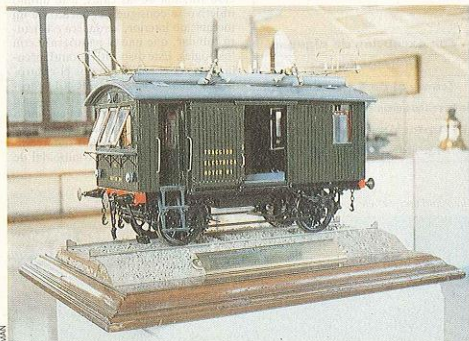
En las locomotoras de la primera electrificación en vía de ancho español, realizada en corriente trifásica, la captación de energía se realizaba mediante arcos con dos portadores independientes, uno por fase.
