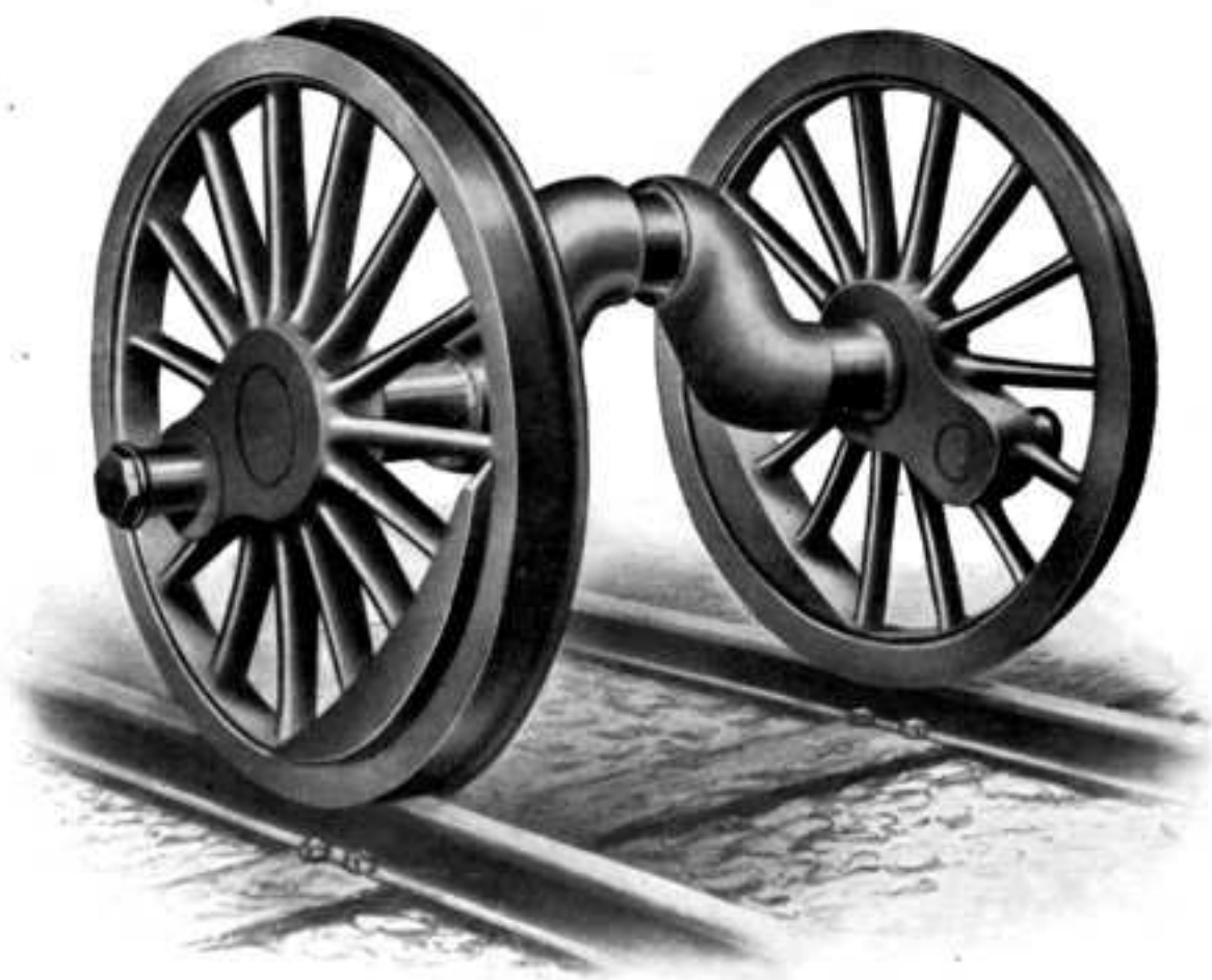
Eje acodado de la locomotora MASTODONTE accionado por el cilindro interior.
