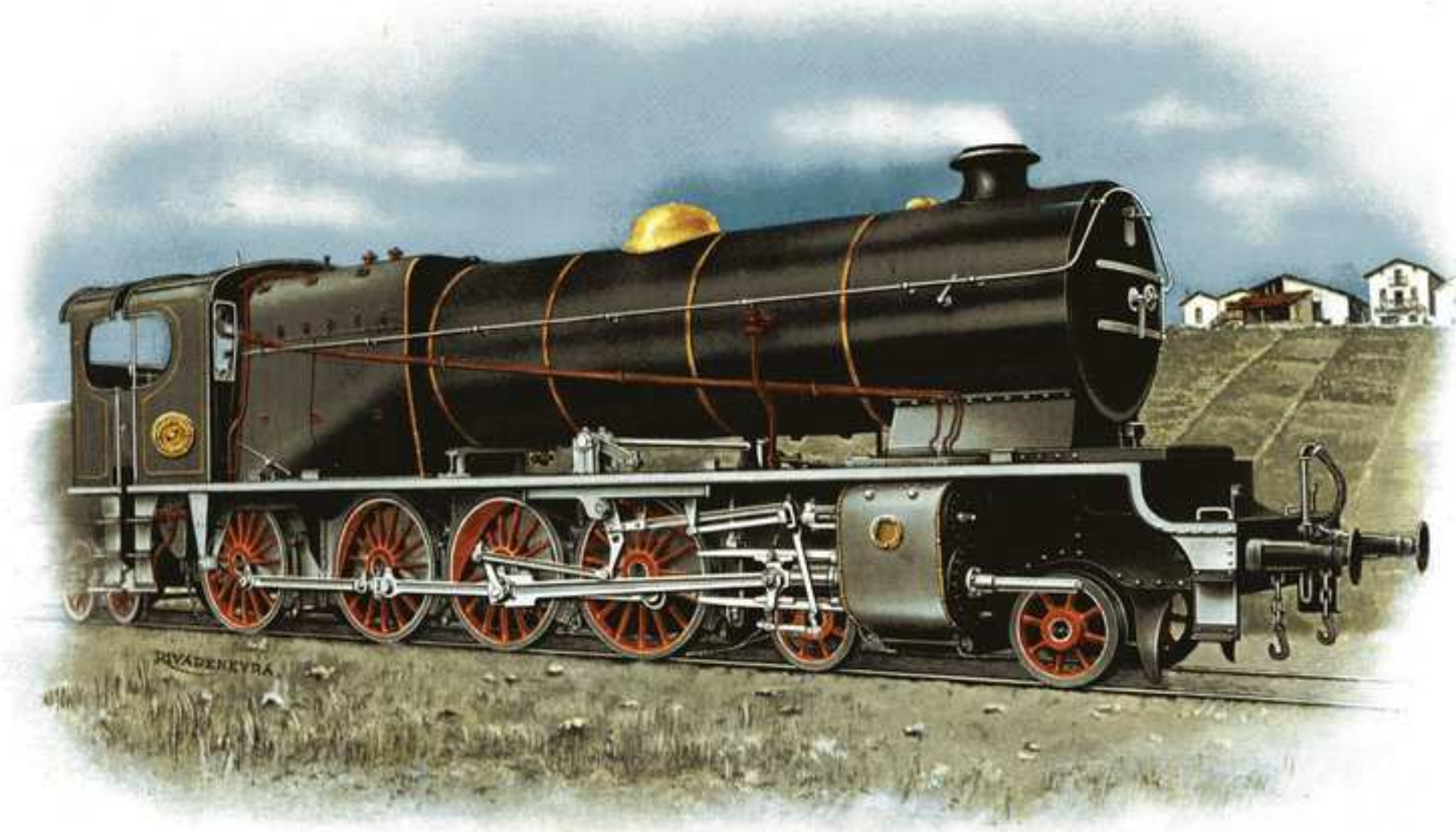
Locomotora MASTODONTE de gran potencia, tres cilindros y simple expansión; construida expresamente para las vías férreas de la península.
