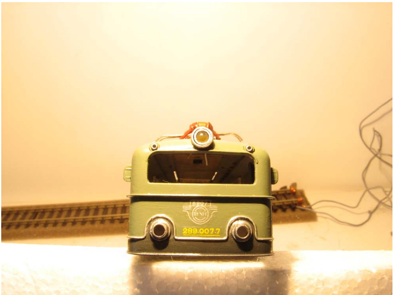
Foco delantero ya colocado.
