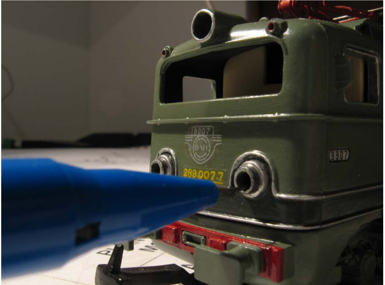
Montamos la carrocería sin los cristales y marcamos con un portaminas, donde van a ir colocados los leds de las luces de posición.
