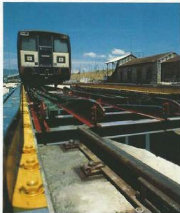
Sistema de cambio de ancho de vía para Talgos con rodadura desplazable. (Foto Talgo.)
