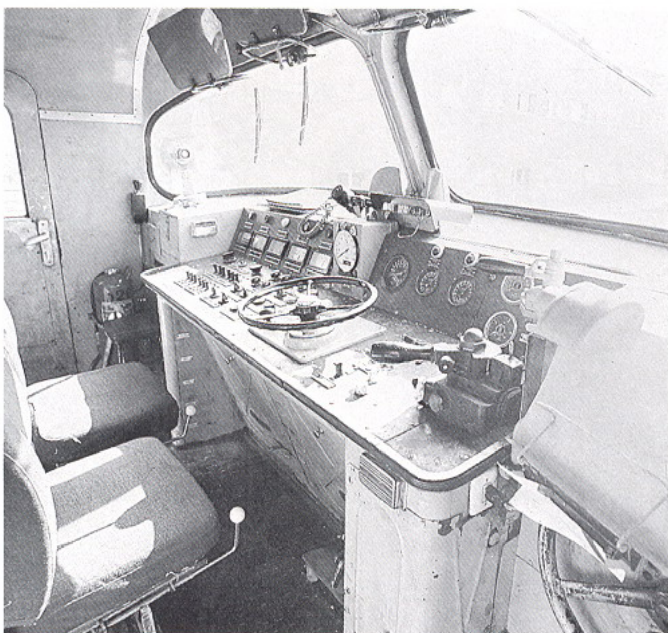
Pupitre de conducción situado en el centro de la cabina.
