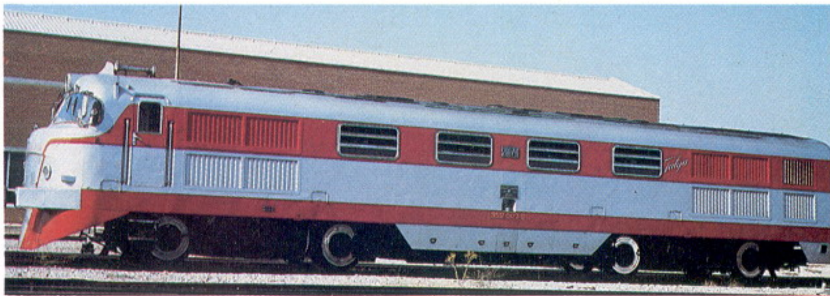
Vista lateral de la locomotora. Unicamente está dotada de enganche automático en la parte posterior.
