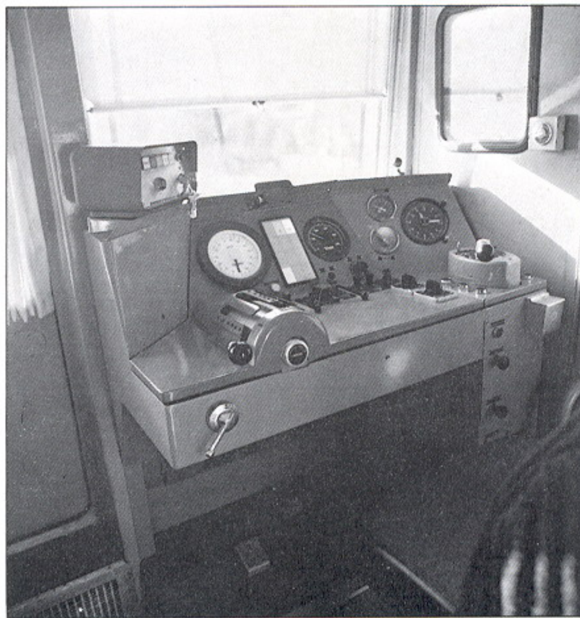
En ambas series el pupitre está situado a la derecha de cada cabina. En la foto de la izquierda, el pupitre del tren serie 592, y a la derecha del 593.
