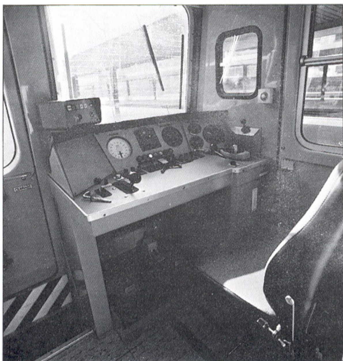
En ambas series el pupitre está situado a la derecha de cada cabina. En la foto de la izquierda, el pupitre del tren serie 592, y a la derecha del 593.
