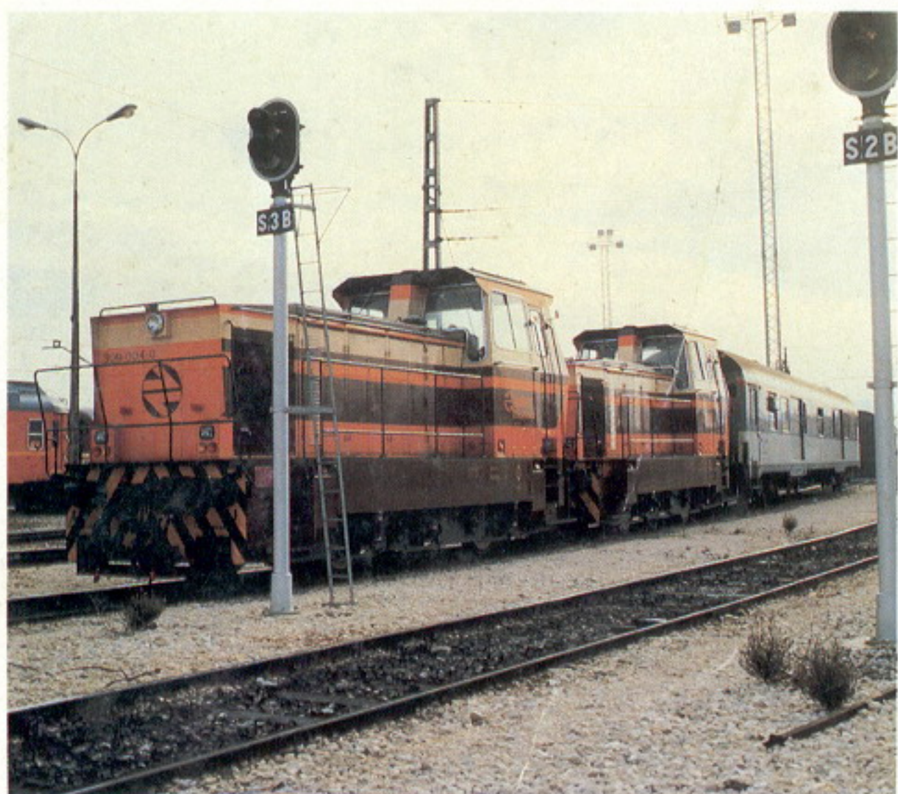
El tractor puede funcionar en mando múltiple, conducido desde el de cabeza.
