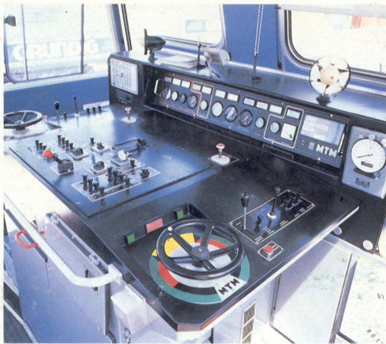
Existe un único pupitre con dos puestos de conducción. Se ha cuidado especialmente la facilidad de conducción.
