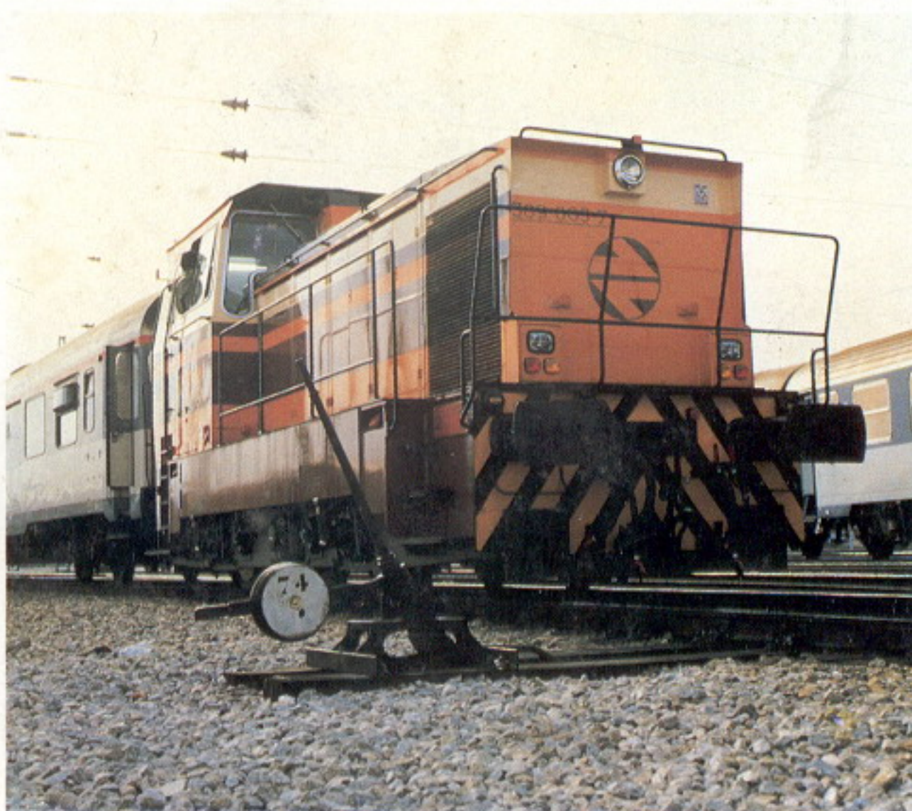
El esfuerzo tractor en el arranque es de 174 kN.
