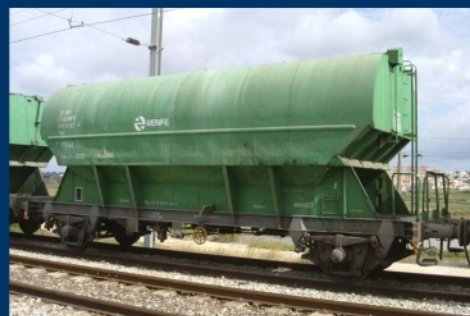
Tolva Tgpps de la Renfe en color verde con bastidor gris
