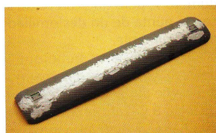
Primera fase de tapado de los agujeros y ranuras con masilla Putty.
