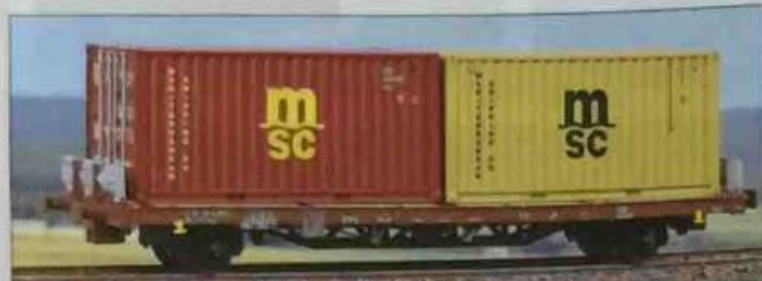
Carro pianale FS Tipo Kgps con due container MSC. Type Kgps wagon of FS with two MSC containers. Flachwagen der FS, Typ Kgps, mit zwei MSC Containern.
