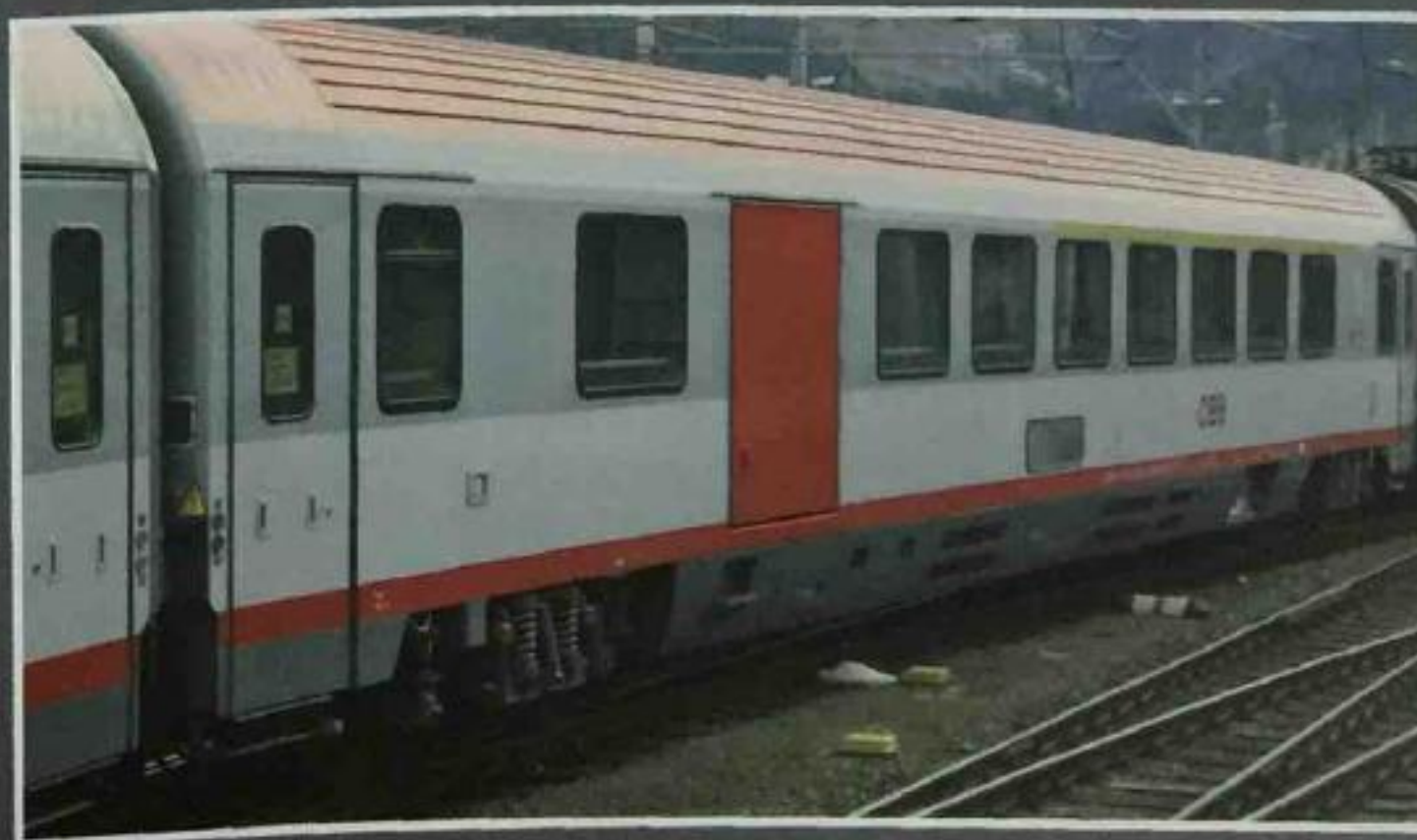
Carrozza ÖBB ADmps di 1ª classe con bagagliaio e comparto capotreno, livrea in due toni di grigio, tetto e striscia rossi. 1st class ÖBB ADmps car, with luggage and service compartments, two-tone gray with red stripe and roof livery. ÖBB 1. Klasse Wagen (ADmps), mit Gepäck- und Zugführerabteil, zweitönige graue Lackierung mit rotem Streifen und rotem Dach.
