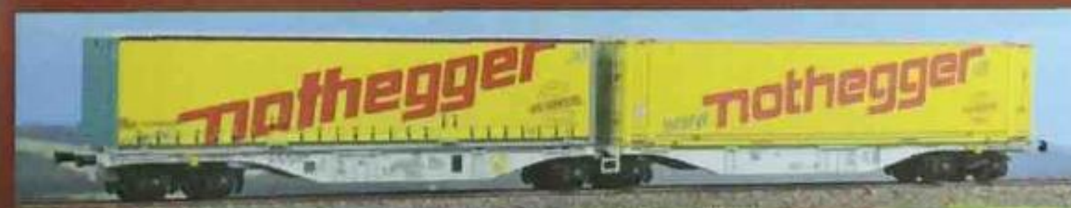
Carro intermodale Tipo Sggmrss '90 bimodulo noleggiato a Lotras S.r.l. con carico di casse mobili "Nothegger". Container wagon Type Sggmrss '90 hired to Lotras S.r.l. with "Nothegger" swap bodies. Containerwagen Typ Sggmrss '90 Doppelmodul an Lotras S.r.l. vermietet mit "Nothegger"-Wechsellpritschen.
