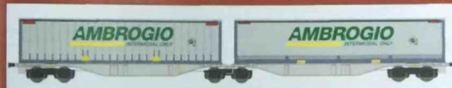
Carro intermodale Tipo Sggmrss '90 bimodulo "Ambrogio" con carico di casse mobili. Container wagon Type Sggmrss '90 "Ambrogio" with swap bodies. Containerwagen Typ Sggmrss '90 Doppelmodul "Ambrogio" mit Wechsellpritschen.
