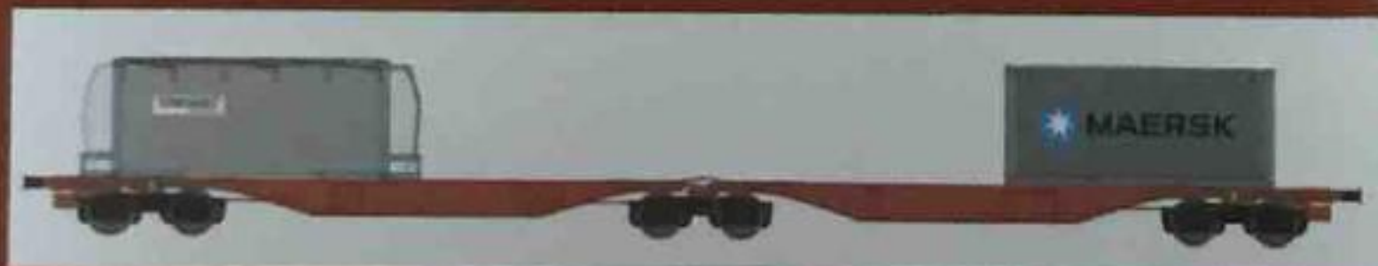
Carro intermodale Tipo Sggmrss '90 bimodulo "CD" con carico di container e cassa mobile cisternata. Container wagon Type Sggmrss '90 "CD" with container and tank swap body. Containerwagen Typ Sggmrss '90 Doppelmodul "CD" mit Container und Tankwechsellpritsche.
