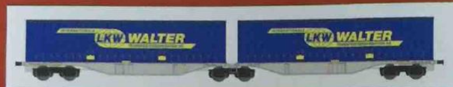
Carro intermodale Tipo Sggmrss '90 bimodulo "CEMAT" con carico di casse mobili. Container wagon Type Sggmrss '90 "CEMAT" with swap bodies. Containerwagen Typ Sggmrss '90 Doppelmodul "CEMAT" mit Wechsellpritschen.
