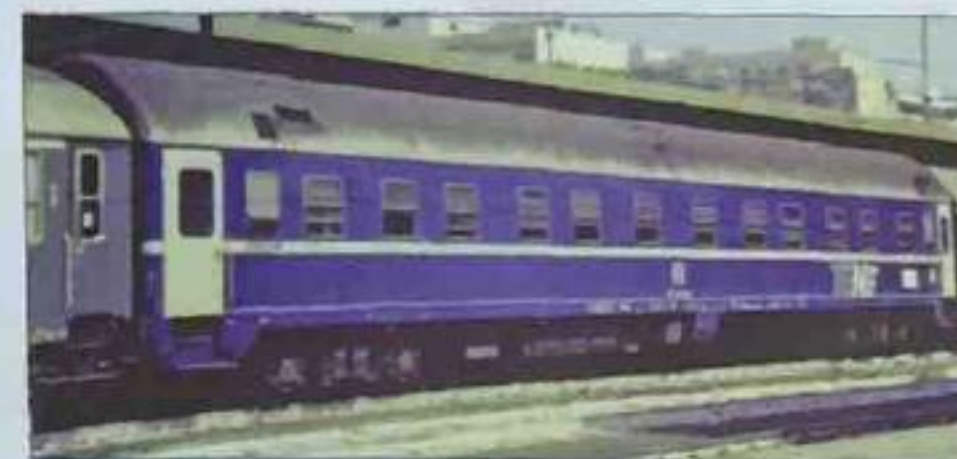
Carrozza letti Tipo YC con carenatura ridotta e bourrellets, livrea TEN. Sleeping car Type YC with reduced skirt and new diagram, TEN livery. Schlafwagen YC mit reduzierter Schürze und neuen Übergängen, TEN-Lackierung.
