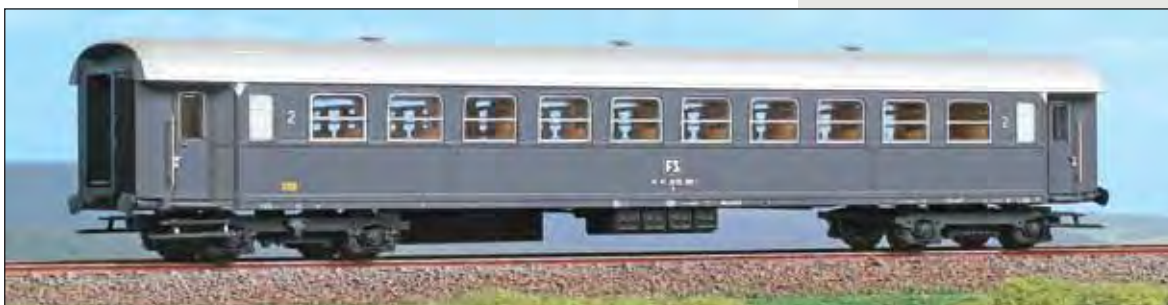
Carrozza di 2ª classe tipo 1956 R (Bz 30.800) in livrea grigio ardesia con finestrini Klein e carrelli 27. 2nd class Type 1956R FS car, slate grey livey, type 27 bogies.
