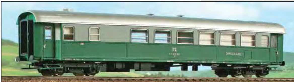
Carrozza Buffet-bar Tipo 1951R delle FS nella inusuale livrea verde e grigia. Carrelli Tipo FS 24 . Italian Railways 1st class Type 1951R Buffet-bar car in gray and green livery. Type FS 24 bogies .
