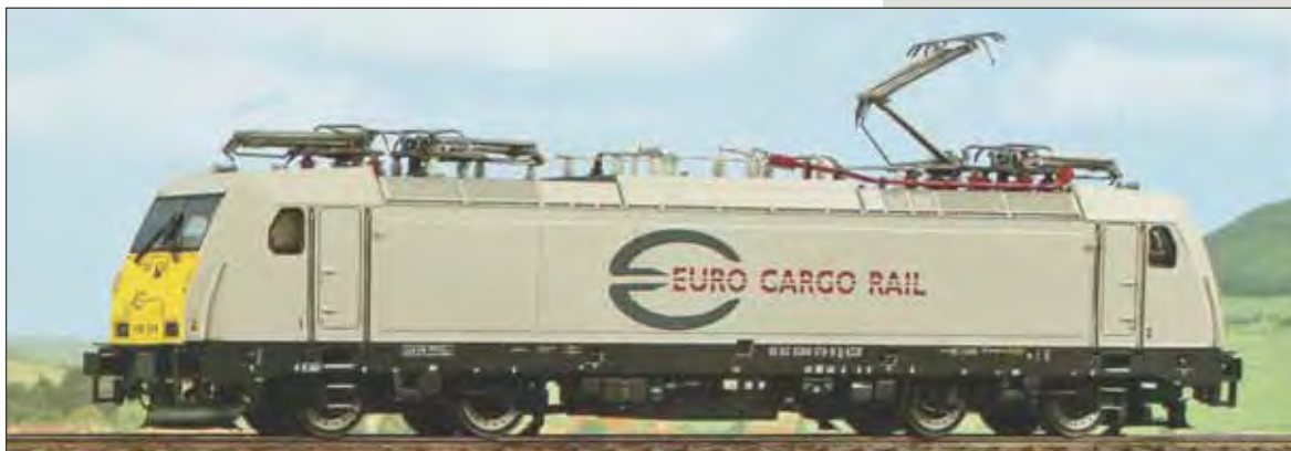
Locomotiva politensione E 186 175 Euro Cargo Rail per i treni internazionali tra Belgio, Germania, Francia. Multi System E 186 175 Euro Cargo Rail used for goods trains between Belgium, Germany and France. E-lok E 186 175 der Euro Cargo Rail für internationale Güterzüge zwischen Belgien, Deutschland und Frankreich.
