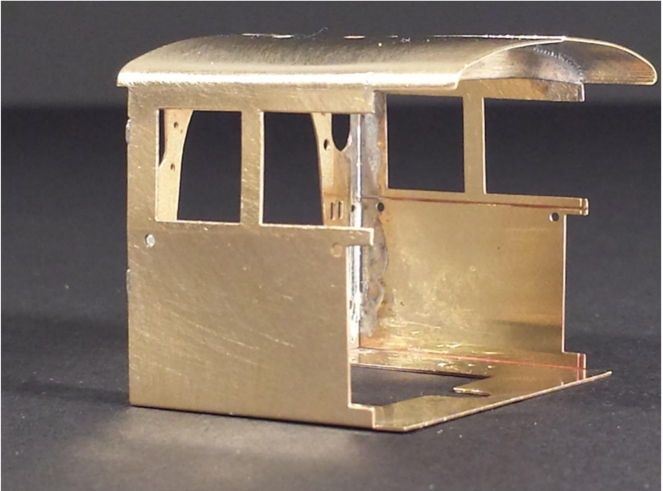
Conformar la pieza 33 y apoyarse con dos varillas de 0.8mm que se sirven .
