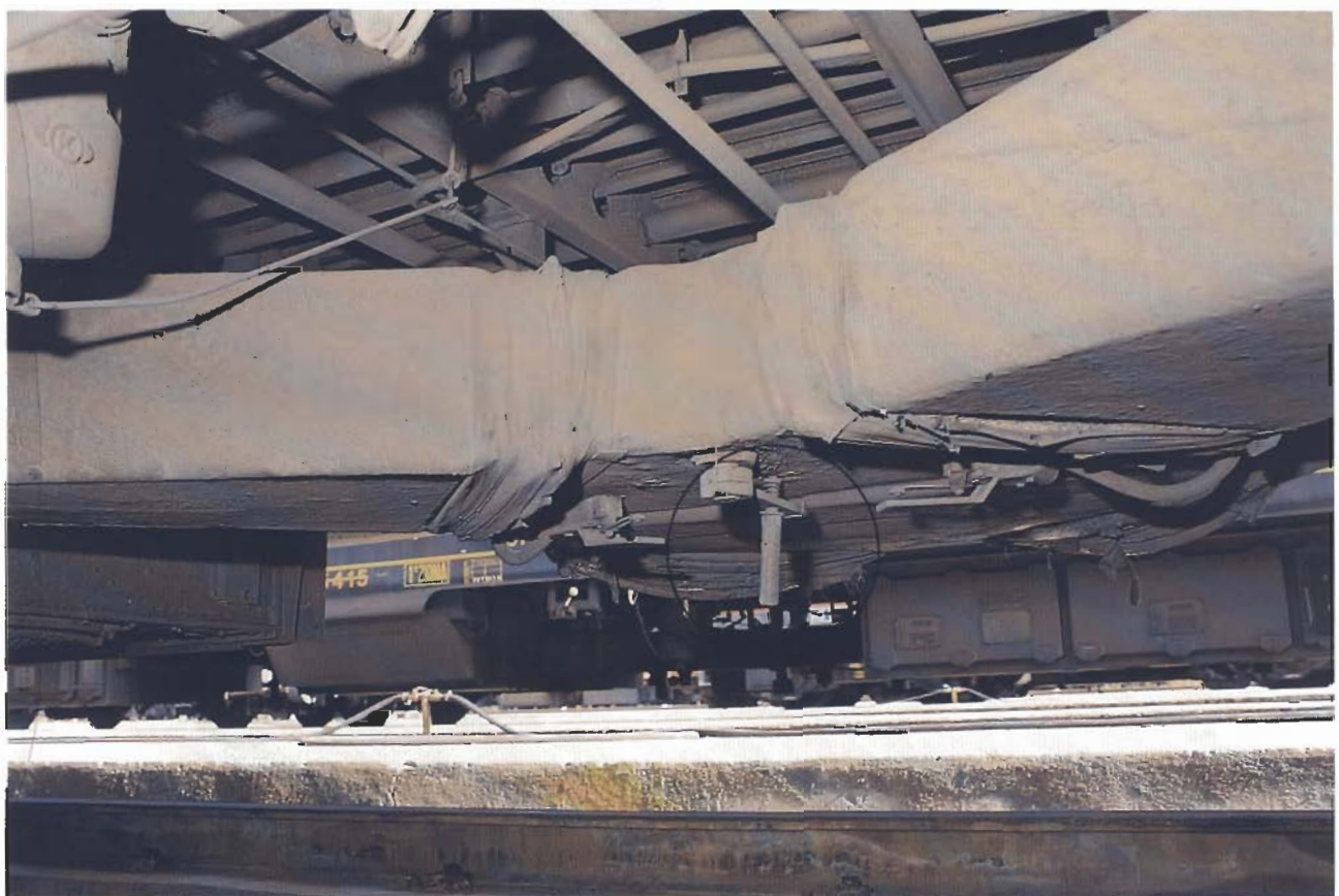
Palanca de la compuerta de emergencia del Aire Acondicionado.
