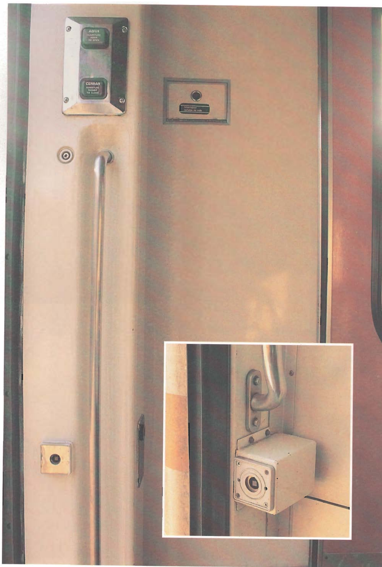
Figura 15 Puerta de acceso encajable-deslizante. Pulsador de apertura y cierre. En el detalle: conmutador de cierre a distancia.
