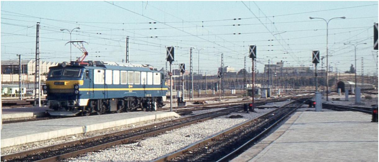
Al cabo de unos minutos, la 251 ha maniobrado por una vía paralela y espera turno para acceder al depósito; al fondo, una 333 está subiendo la composición a Fuencarral; los 4 furgones habrán quedado en la vía de recepción para ser maniobrados mediante tractor por la otra cabecera con destino a las vías específicas ( paquexpres, correos, auto-expreso ). Maniobras ferroviarias ALTAMENTE DEFICITARIAS, ahora impensables !!!
