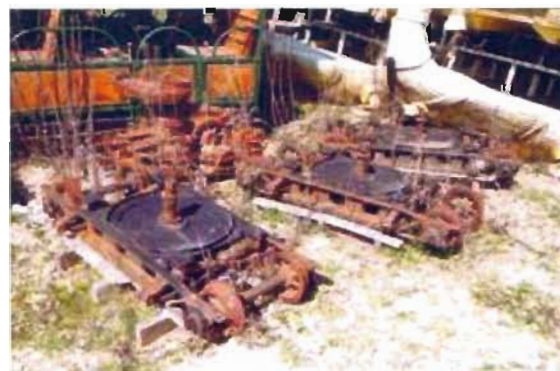
Bogis dels vagons de passatgers amb el sistema articulat "JAKOB"
