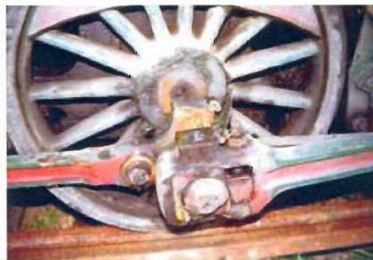
L'eix central sense els elements de la distribució de vapor.
