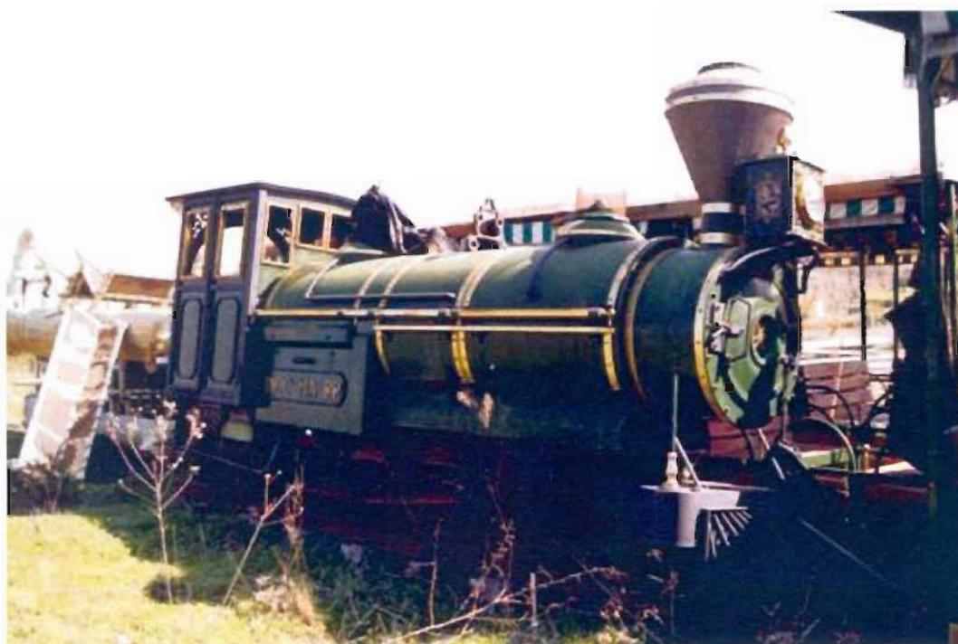
La locomotora Krauss 8473, propulsada per un motor dièsel i decorada amb estil pseudoamericà.
